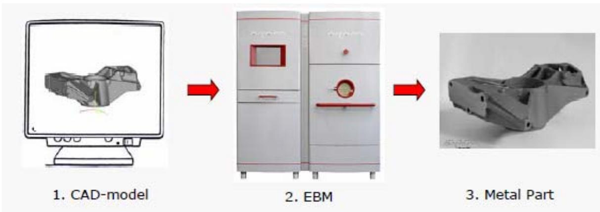
圖 22. Arcam 所發表的電子束熔融設備作動模式。
