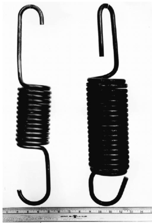
圖 14. 鈦合金與碳鋼所製程的彈簧分別位於圖中的左側與右側。
