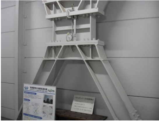
照片 6 FUJITA 公司試驗室減震設計(一)
