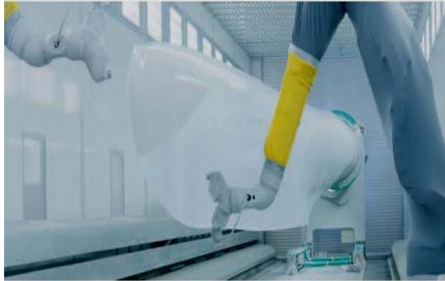
葉片拋光後最後階段--無塵室多層次噴漆
