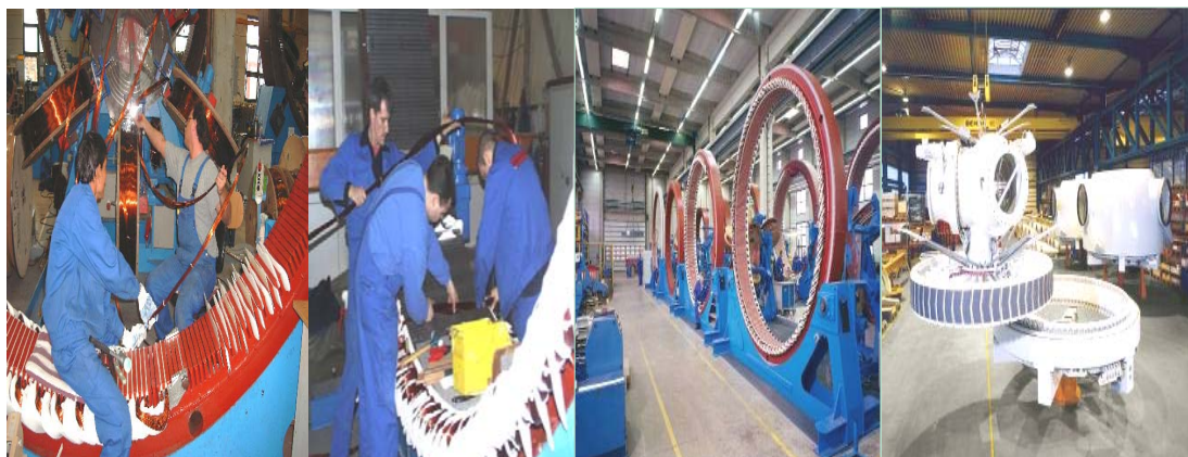
圖 1&2 三相定子線圈手工嵌入過程
