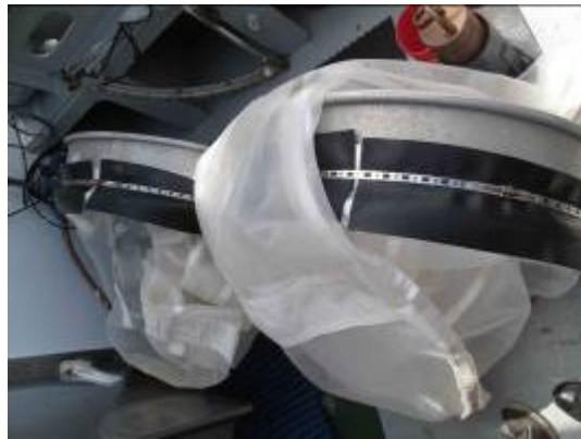
圖 28. 研究船上之水平動浮採集網 (Bongo)
