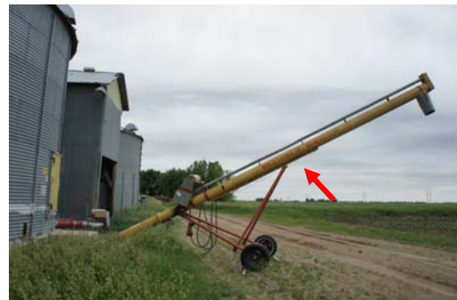
圖 100、連接穀倉與運輸車之牽引運送設施
