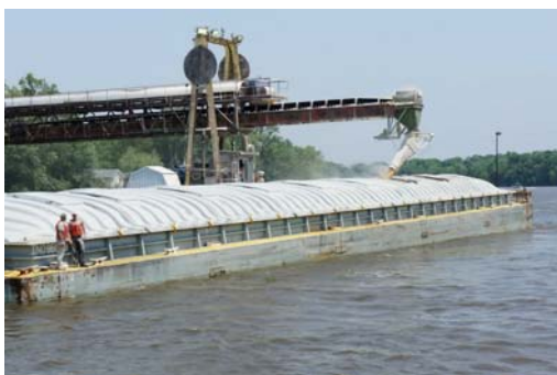
圖 25、終點穀倉（Terminal elevator）將玉米裝入駁船內之作業情形
