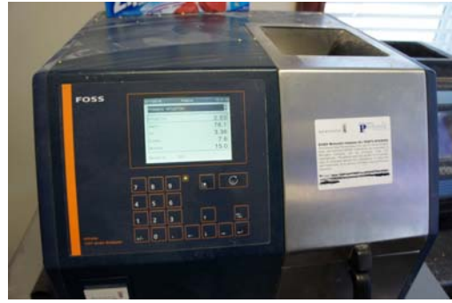
圖 112、採樣玉米樣本送機器檢驗含水量、油脂、蛋白質、澱粉等
