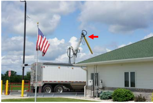
圖 111、進場前玉米品質檢測（由箭頭處儀器進行採樣）
