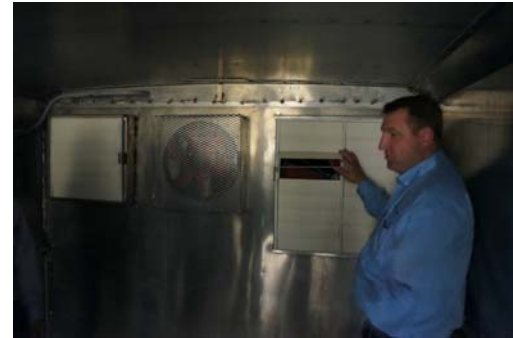
圖 82、Dr. B.R. Kerkaert 向團員展示運輸 PRRS-free 豬隻運輸貨櫃內之濾過系統
