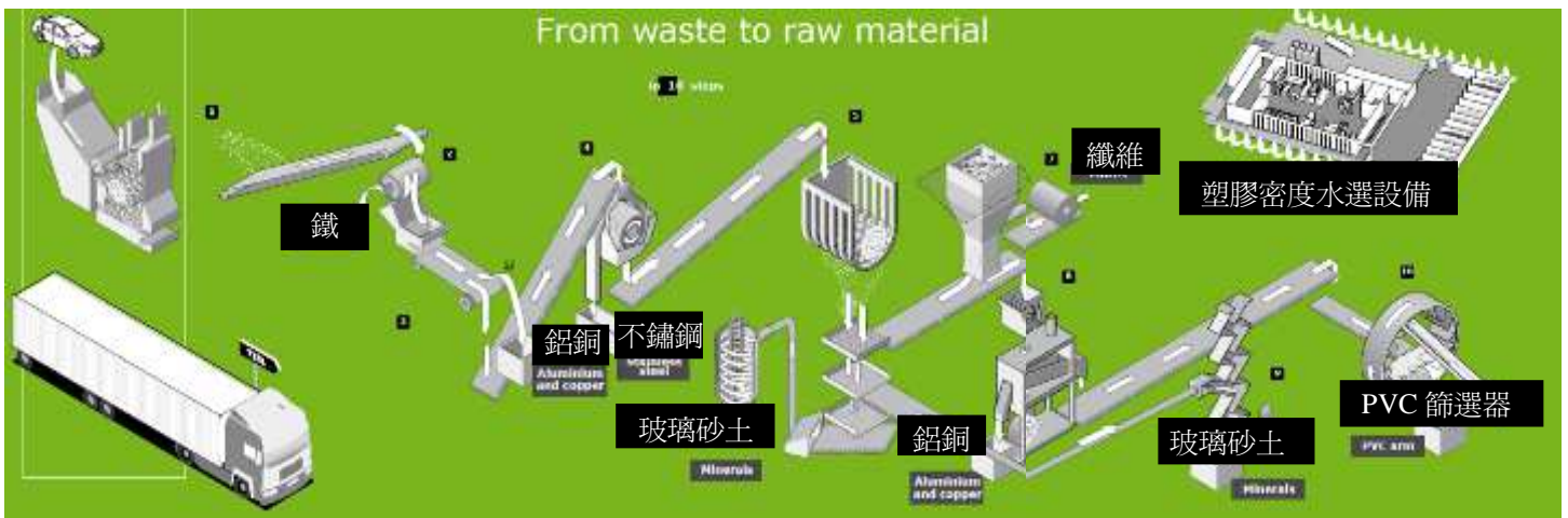
圖十四 後破碎技術(PST)處理程序
