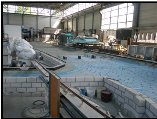
達姆斯達特工業大學實驗室中萊茵河某河段的水理試驗水工模型
