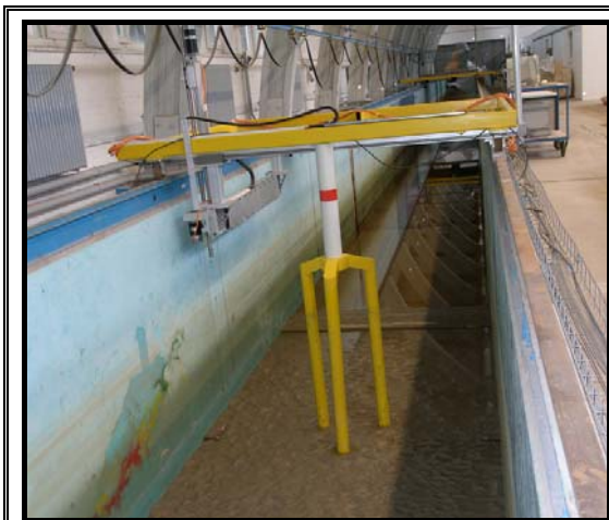
漢諾威大學實驗室內的風力發電柱基礎之渠道水工模型
