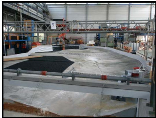
達姆斯達特工業大學實驗室中的河岸保護工設施水工模型
