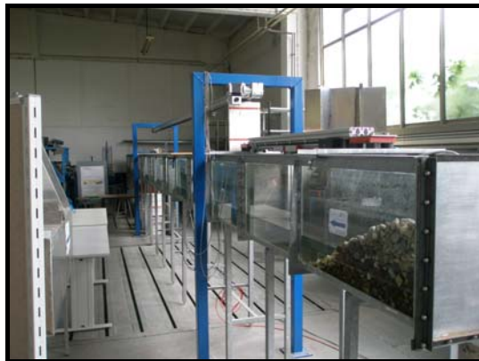
羅斯托克大學實驗室水槽等水工模型設施
