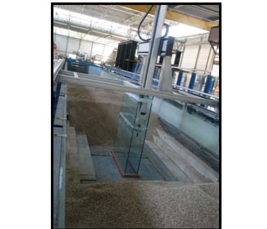
實驗室橋墩沖刷試驗水工模型
