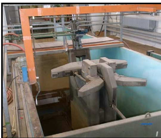
漢諾威大學實驗室內的渠道水工模型的造波機
