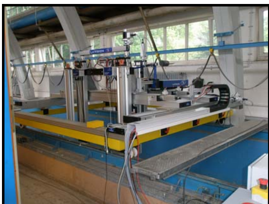
PIV(Particle Image Velocimetry)觀測系統—觀測端
