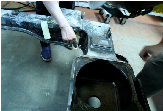
直達車量產車轉向架焊道檢查情形
