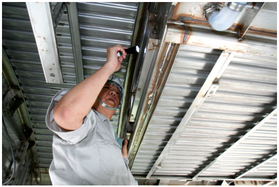
直達車車體水密測試
