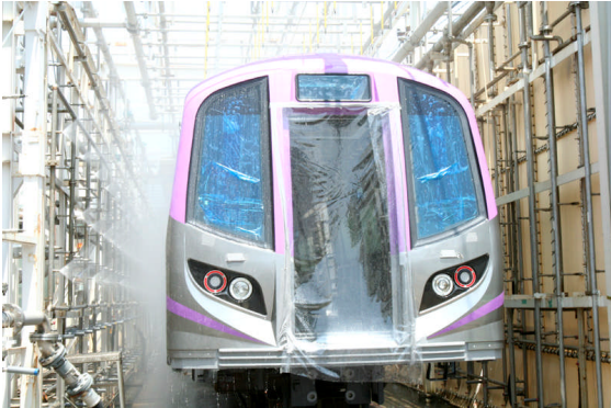
直達車車體水密測試
