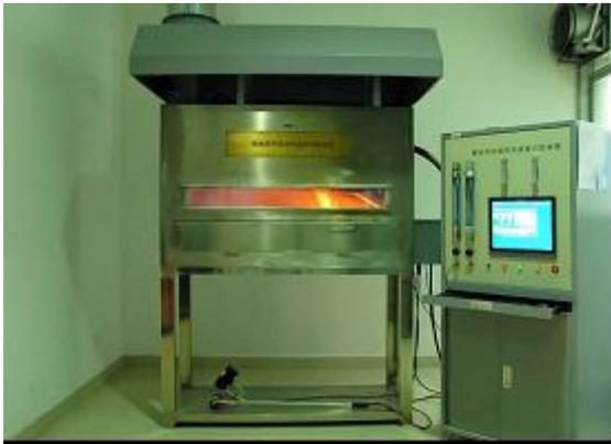
鋪地材料輻射熱通量試驗裝置
