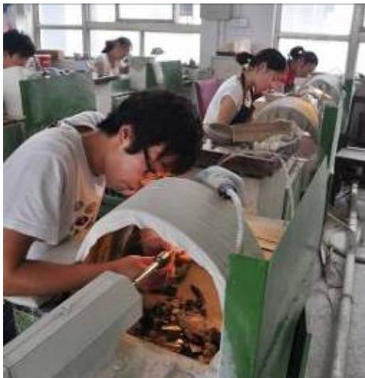
(圖 10)揚州漆器廠—玉雕元件細工研磨作業區
