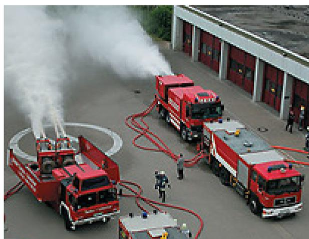
圖 11 渦輪滅火消防車剪影
