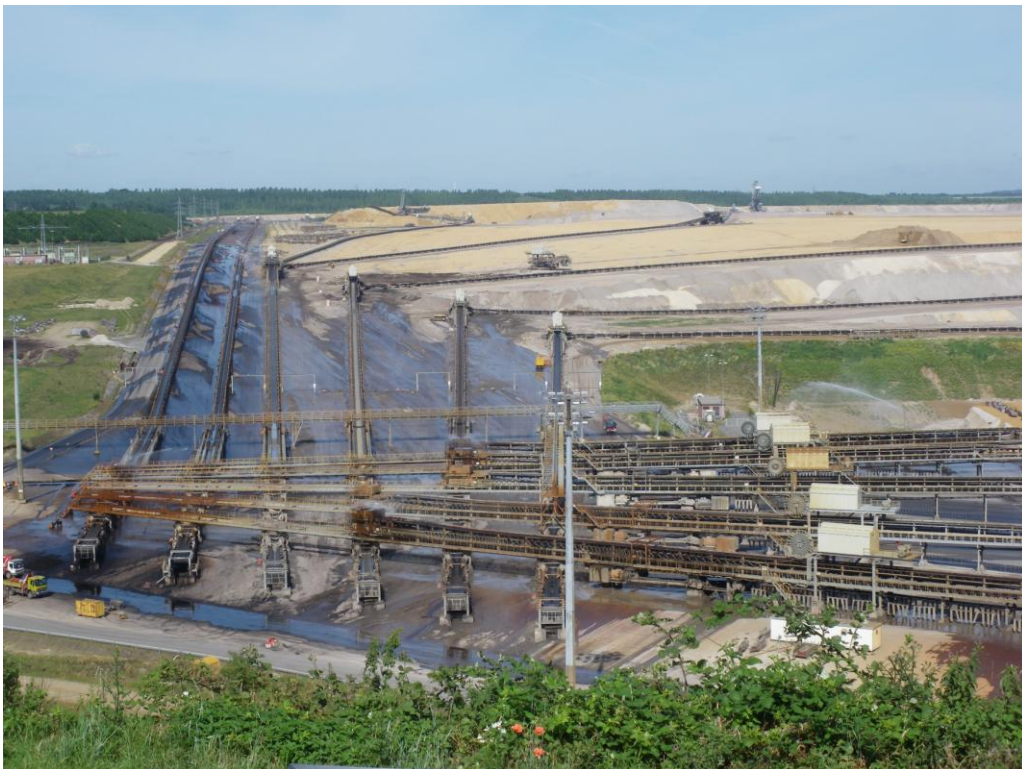
照片 9 Inden 煤礦露天採煤與表土輸送轉運設備佈置-包括噴水壓制粉塵措施。
