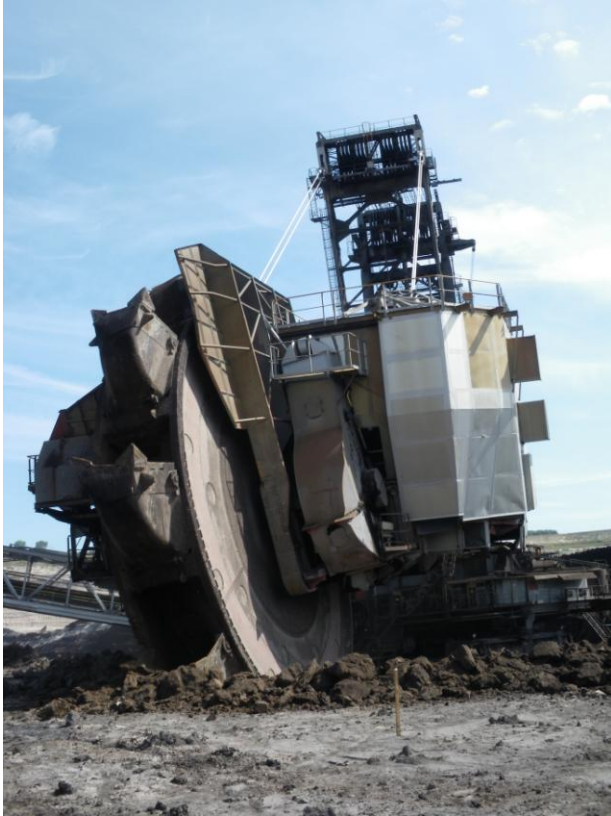
照片 8 作業中斗輪式鏟礦機每日採取量可達 240,000 公噸或表土/立方公尺。
