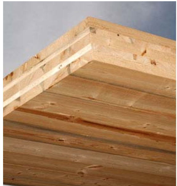
圖21、參訪CST Innovation公司，討論直交積層木材(Cross laminated timber, CLT)的製造與市場應用現況
