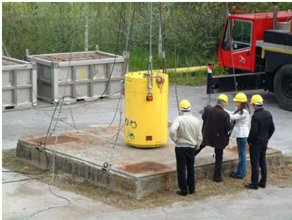
圖六、義大利 Sogin 公司 \alpha 廢液水泥固化系統實體照片(二)
