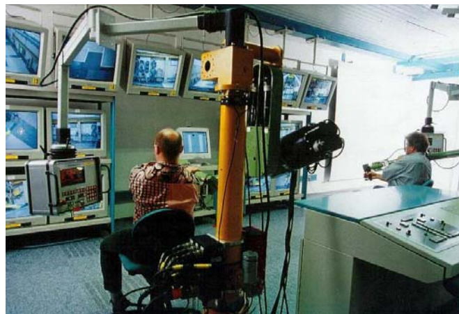
圖十五、德國 WAK 遙控拆除控制室
