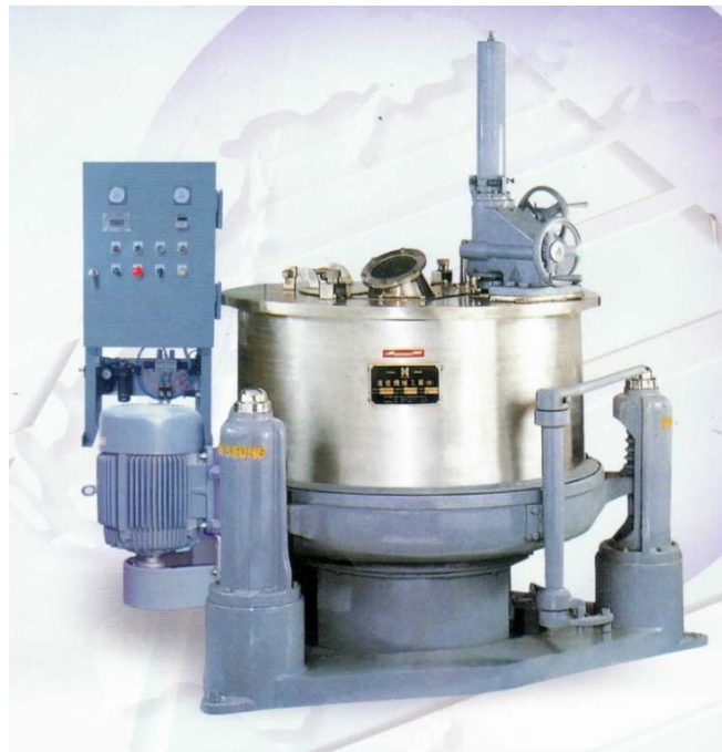
圖二、韓國 KAERI 污染泥土除污系統進料設備及固、液分離設備
