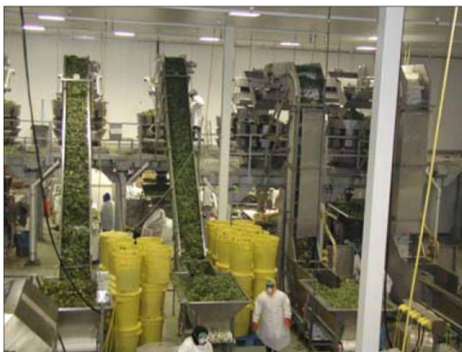
圖 17. 新鮮截切蔬菜生產線(圖片來源: UCD 採後處理技術中心)
