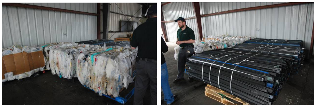
圖 39. 批發市場內回收的塑膠袋(左)，可以重製成固定棧板上的貨物用的塑膠條(右)。
