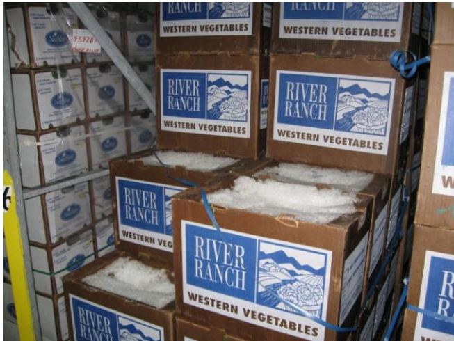
圖 5. 碎冰預冷是將產品包裝於防水紙箱中，再將流冰灌入。
