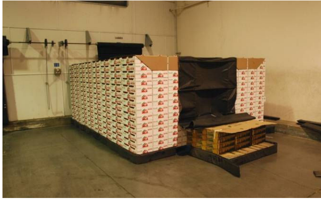
圖 7. 壓差預冷是利用強制抽風使冷空氣從紙箱側孔進入紙箱中，加速產品降溫。
