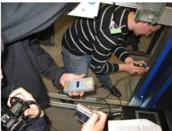
圖 62. 手動開啓力道量測
