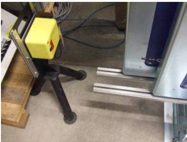
圖 72. 安裝線性編碼器於測試機台
