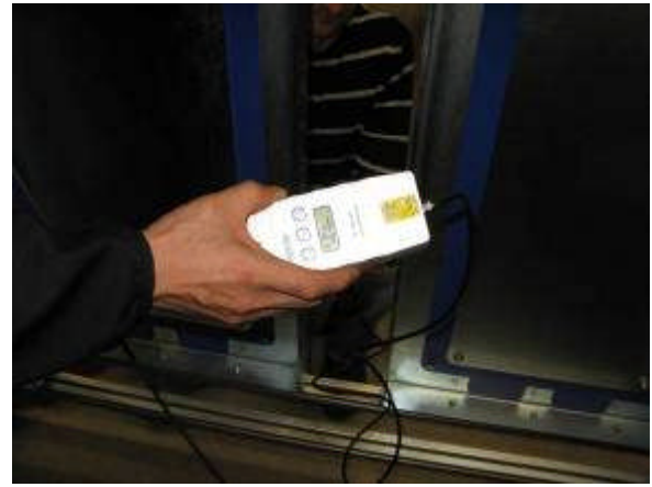
圖 75. 量測關門力道實測數據
