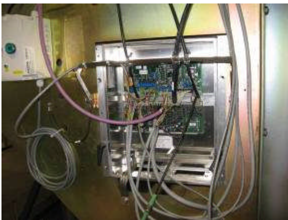
圖 48. 半高式滑門控制單元－確認接線 將滑門控制單元安裝至測試機台上(如圖 48.)，目視檢查下列項目：檢查確認所有螺絲已鎖緊，檢查確認所有連接或鎖件無鬆脫，且所有項目都已適當固定、鎖緊設定滑動架(懸吊)。
