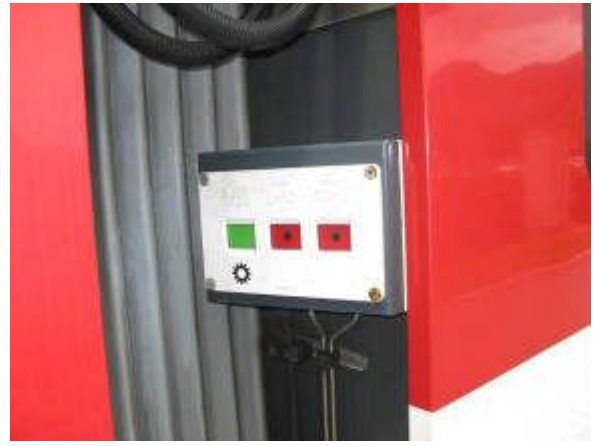
圖 156. 輕軌電車連結控制盤
