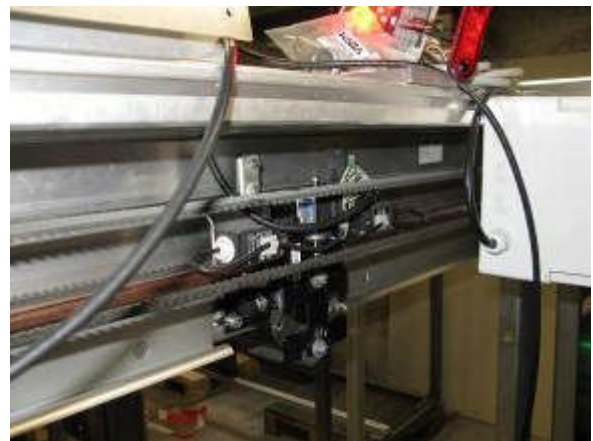
圖 57. 滑動架上所有的滾輪必須滾動
