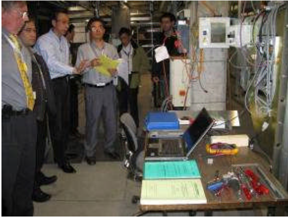
圖 40. 測試文件與儀器一字排開待檢證 測試設備包括有三用電錶、線性編碼器、示波器、厚薄規、筆記型電腦、測速計及荷重法碼等等。
