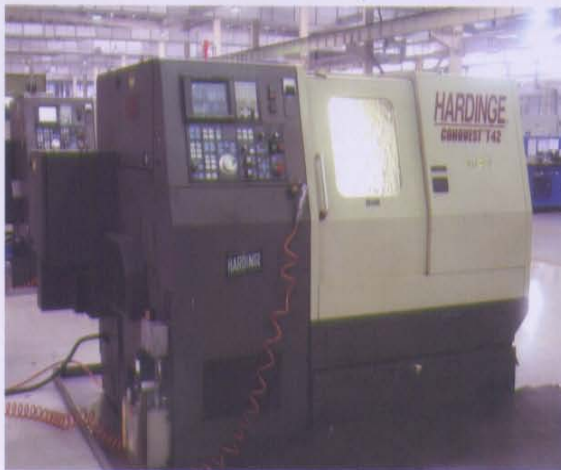
美国哈挺T42数控车，加工精度高。
