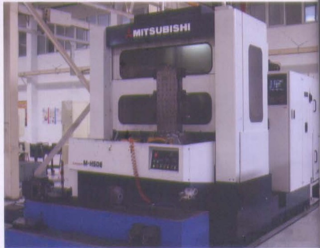
日本三菱M-H50E加工中心。主要用于自动制动阀体的加工，精度高。
