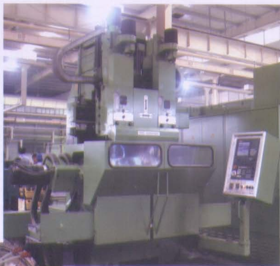
双轴五坐标计算机控制铣床加工增压器压机叶轮、身风轮、整体叶轮及五轴联动曲面加工
