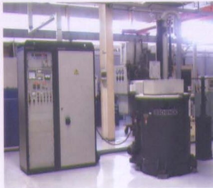
叶轮、导风轮在内孔加工前进行预应力超速试验。
