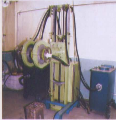
XYD-3010B型金属陶瓷管X射线探伤机，本设备可对多种金属材料制成的零部件或焊缝进行无损检测。
