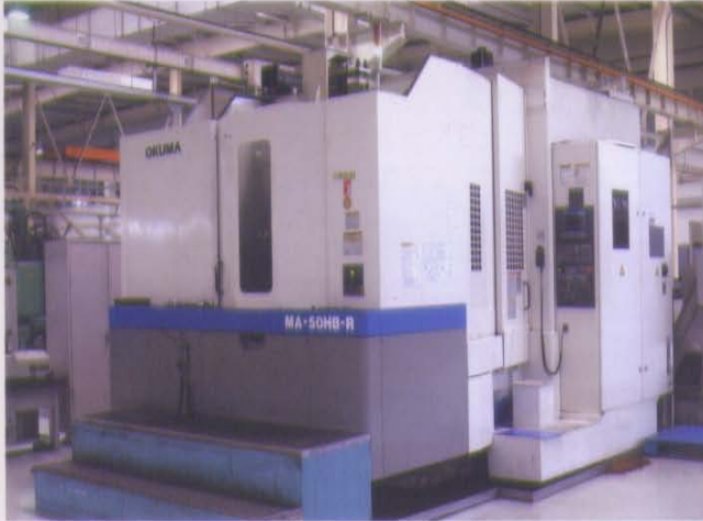
日本大隈MA-50HB-R卧式加工中心，用于副阀体的加工，生产效率高。
