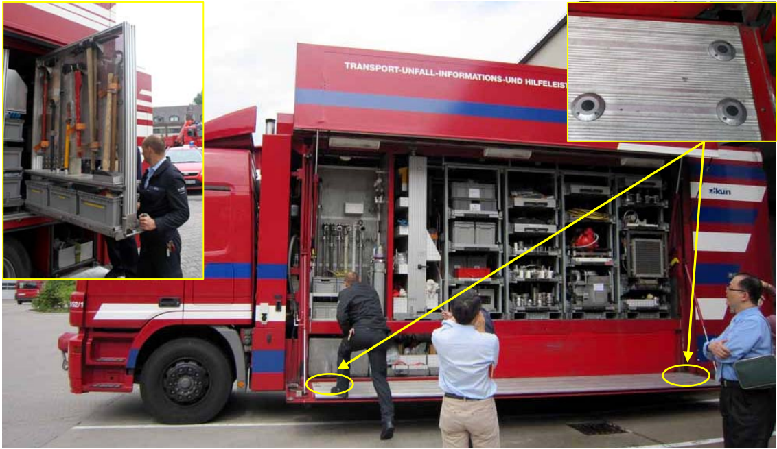
圖 22 BASF 消防隊所屬之 TUIS 緊急應變車（黃圈為兩組升、降及安全按鈕）
