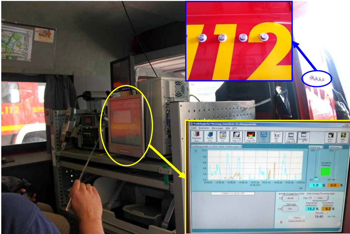
圖 33 輻生化偵防車內部（右上：外部偵測口；右下：危害濃度曲線）
