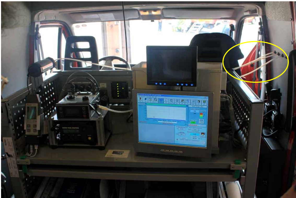
圖 34 Wuppertal 消防隊輻生化偵防車內部一瞥（黃圈為採樣口至分析儀之管線）
