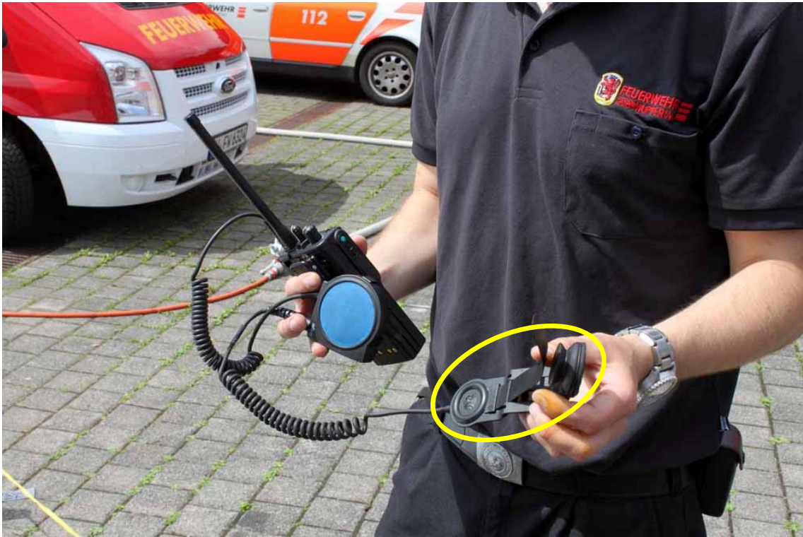
圖 37 佩戴於 A 防內部與外界通話之無線電對講機與震動式發話器（黃圈）
