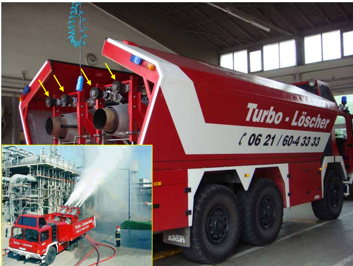
圖 21 BASF 消防隊之渦輪增壓滅火器（黃色箭頭處為其四個噴嘴）
