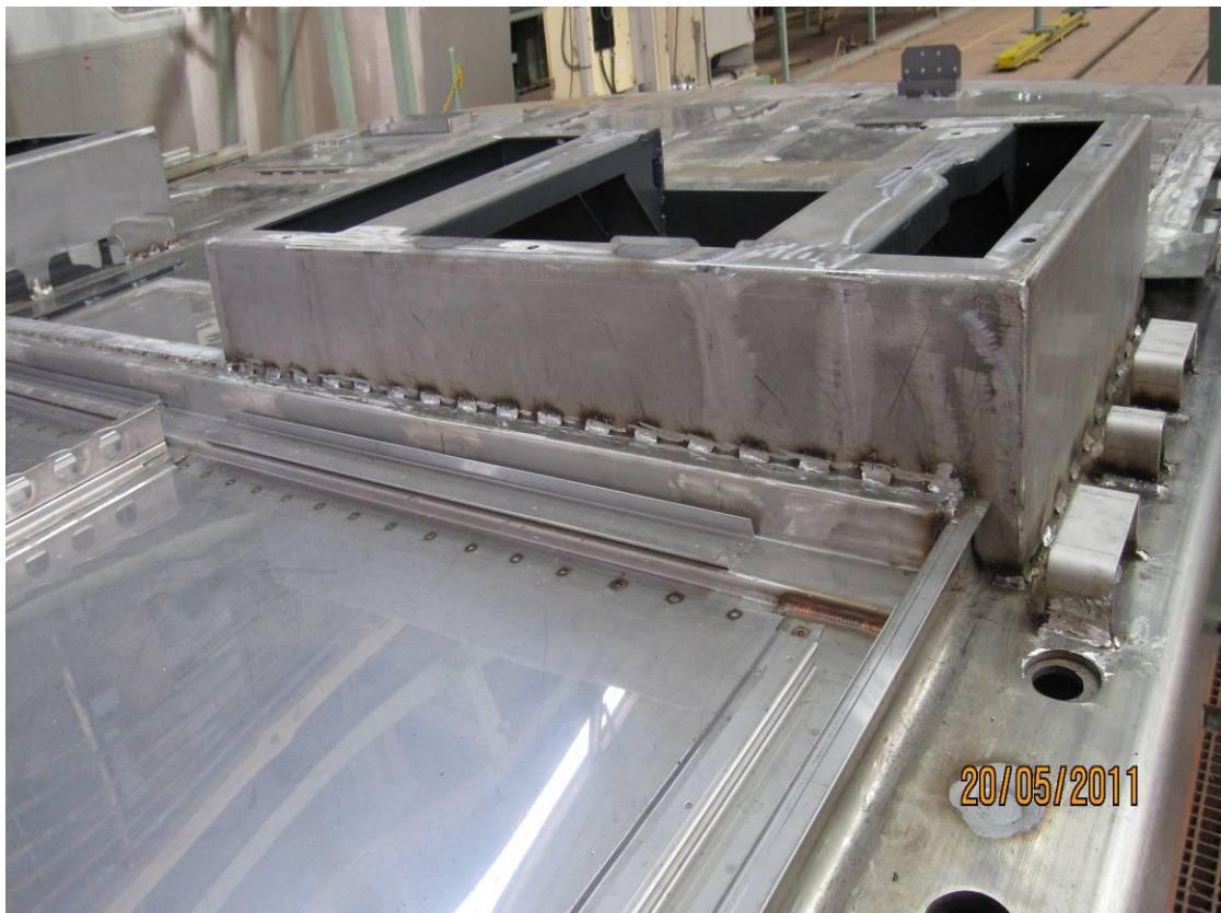
照片 10. 車廂地板銲接製程實況
