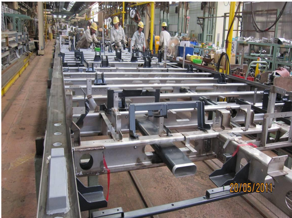
照片 8. 車底框架支架銲接製程實況
