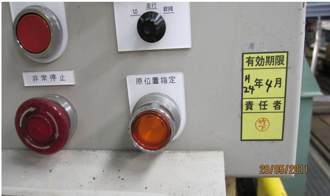
照片 14. 車體組立銲接設備有效校準期限實況
