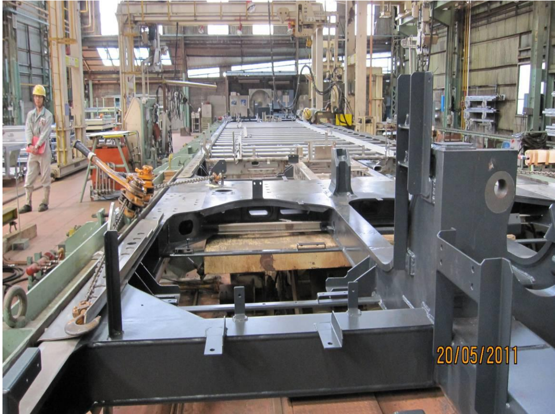
照片 7. 車底框架銲接製程實況(二)
