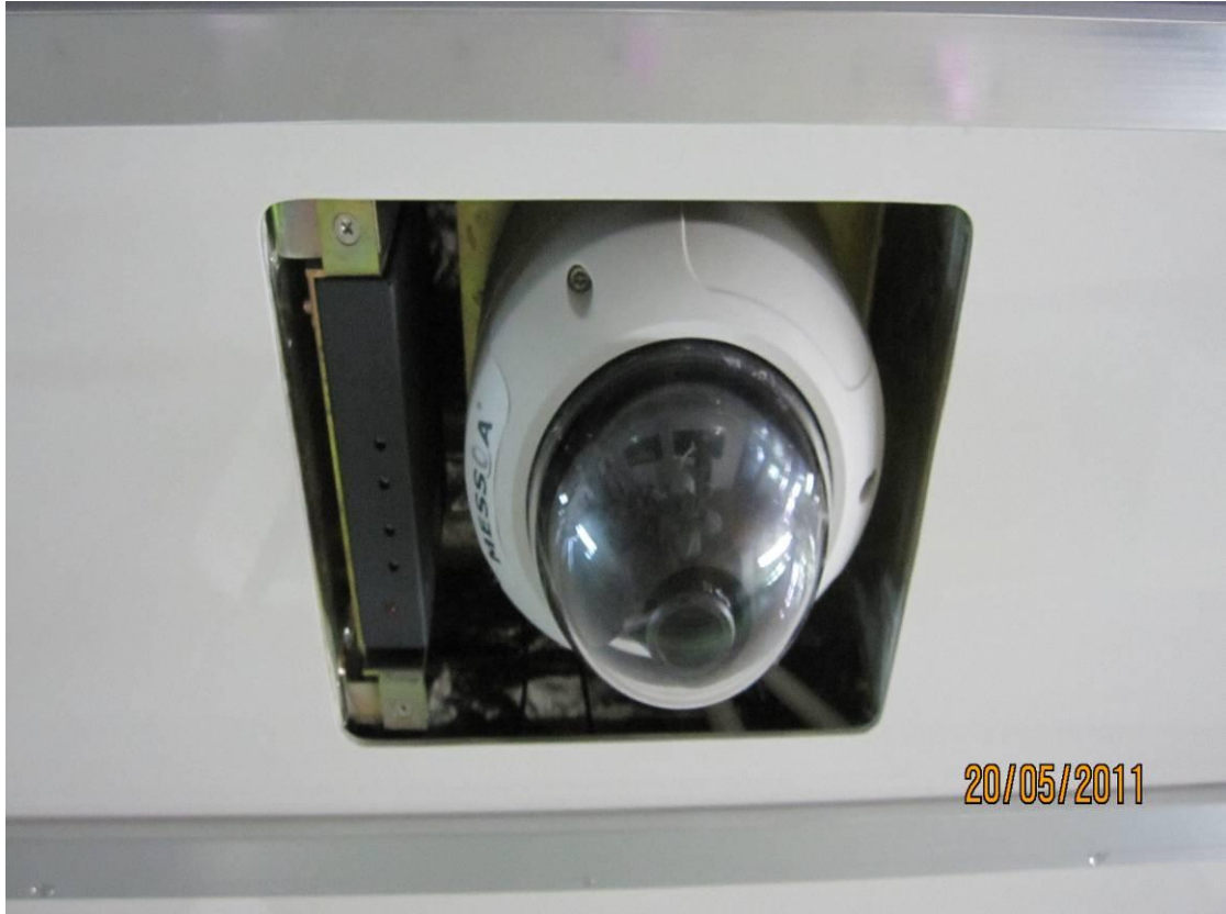
照片 27. 車廂 CCTV 攝影機組裝製程實況
