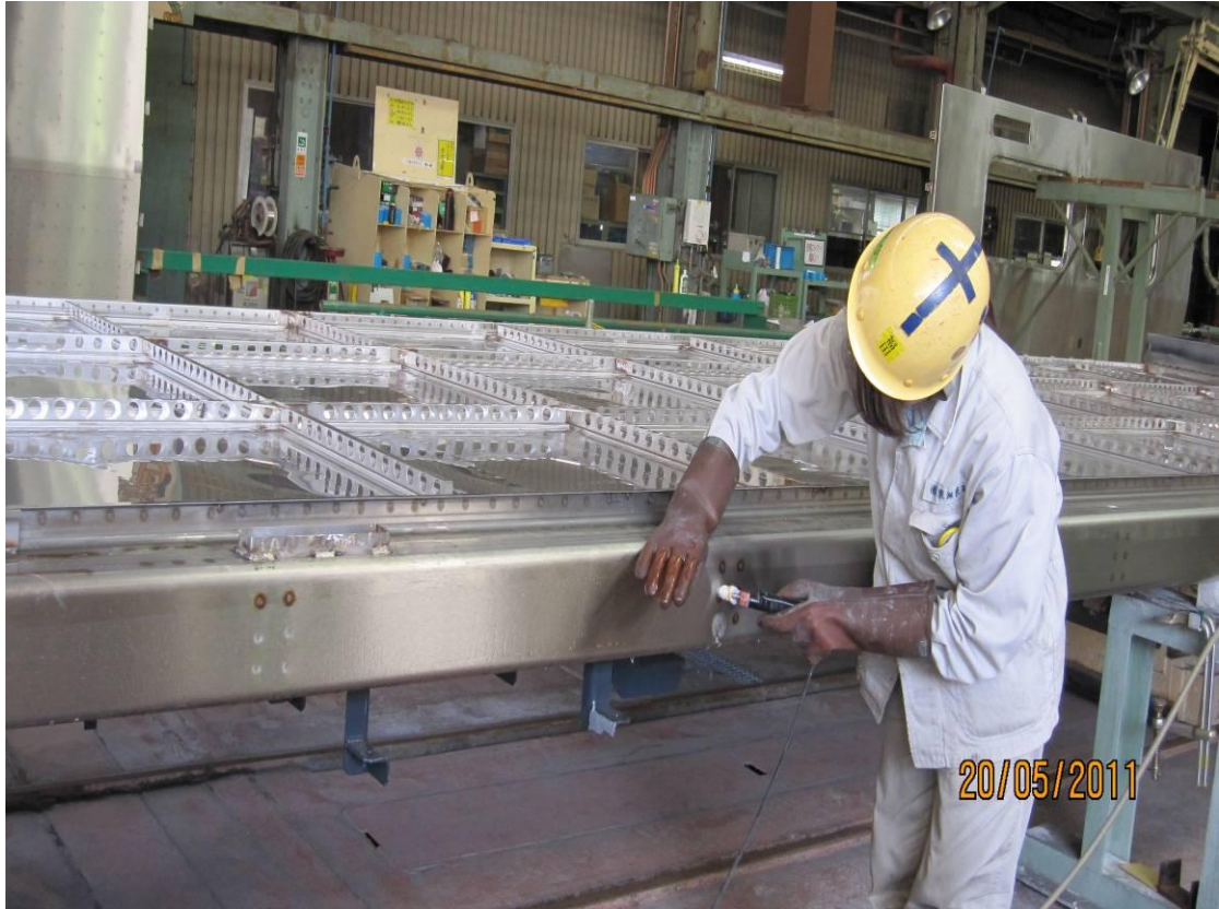
照片 9. 車底框架銲痕清除製程實況
