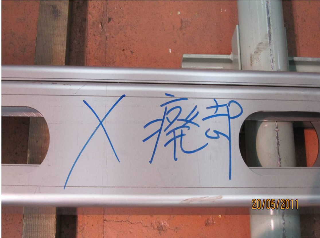
照片 5. 車底框架橫樑不合格品檢視實況
