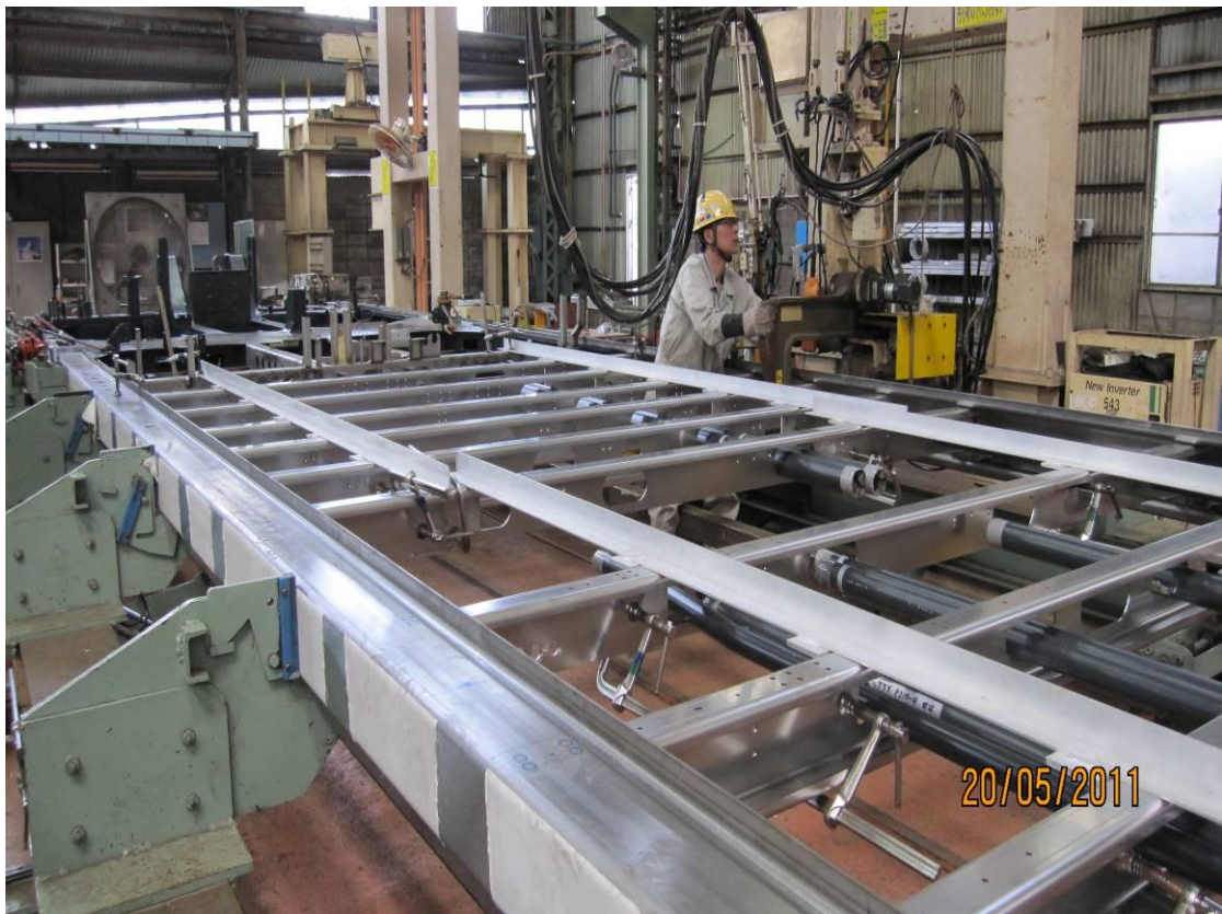
照片 6. 車底框架銲接製程實況(一)
