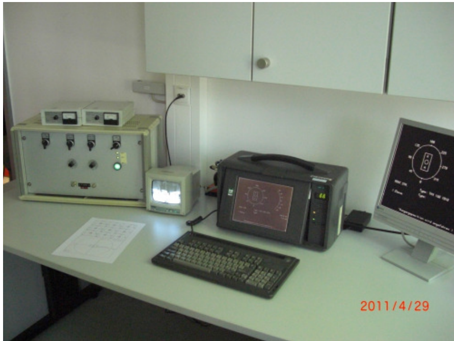
圖 25 X 光管洩漏劑量量測設備-控制室
