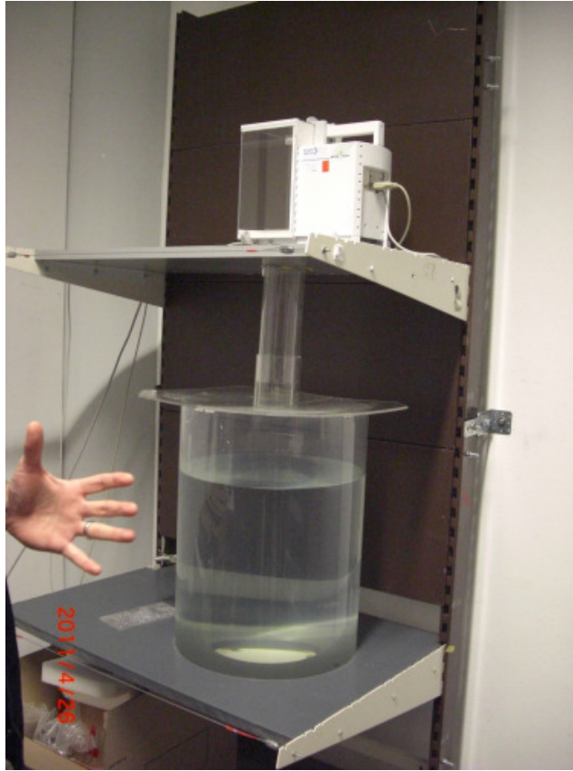
圖 9 超音波強度、輸出功率測試驗證系統聲-2
