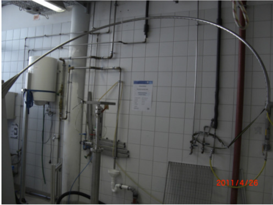
圖 5 防水試驗設備
