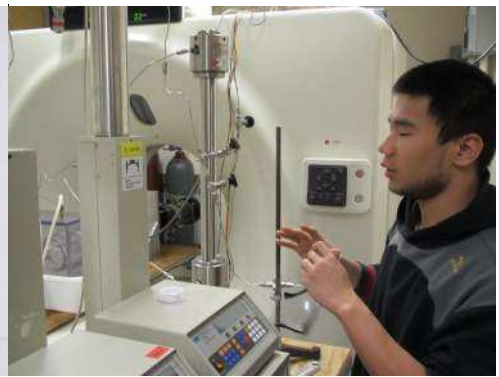
圖 39 鋁製試體室移入 X 光電腦斷層掃描儀
