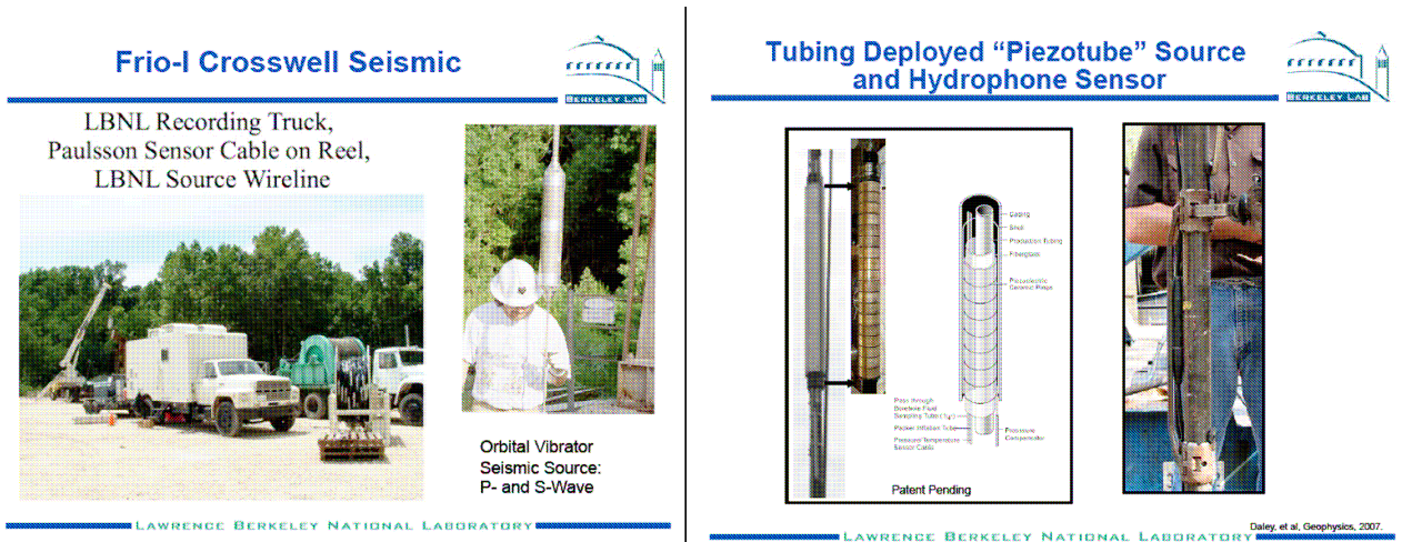
圖 18 LBNL ESD 新式井內震源設備現場操作實況
