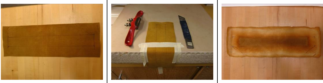
使用刨皮刀(左)或削皮刀(右)，將皮革邊緣打薄，以利之後的使用。
