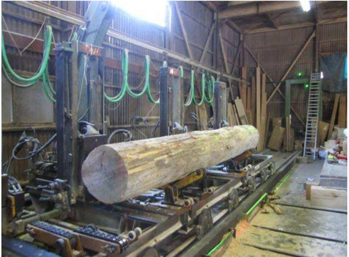
剝皮後之原木，製材時，使用雷腦模擬並以雷射定位後，再製材，以達最佳之選材及製材率
