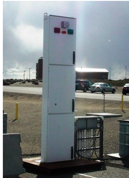
圖 9：輻射入口監視器。
