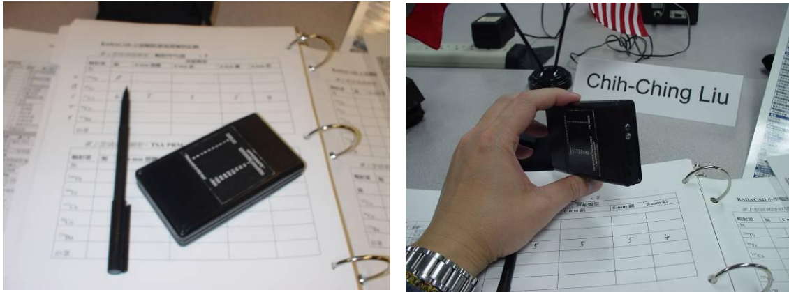
圖 2：輻射偵測呼叫器，攜帶於身上作為偵查輻射源之用
