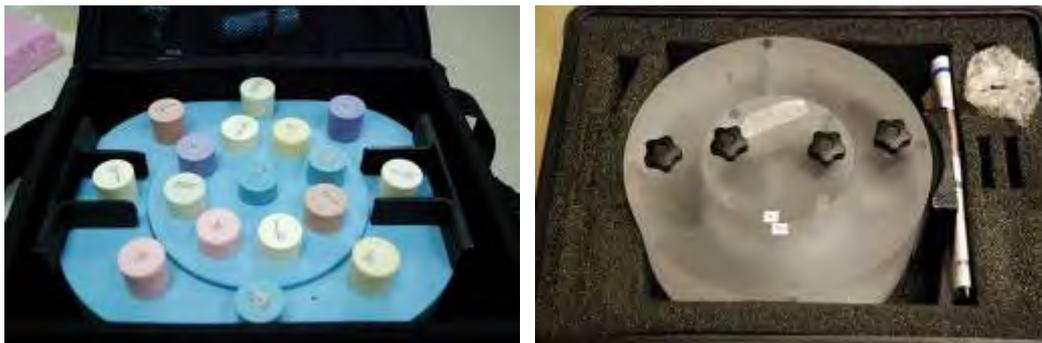
圖 19：CT 品保作業相關假體。左圖：電子密度假體（CIRS 062）；右圖：CT 劑量假體
