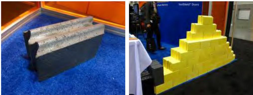
圖 7：新的屏蔽材質（VeriShield™），可使用於高能量之光子射束及粒子射束。密度  $4\text{-}5\text{g/cm}^3$ ，每一塊尺寸約為  $5''\times 5''\times 10''$ 。
