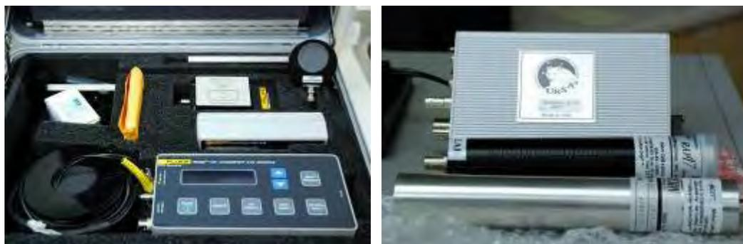
圖 20：左為管電壓（kVp）測試儀器，右為核種分析儀
