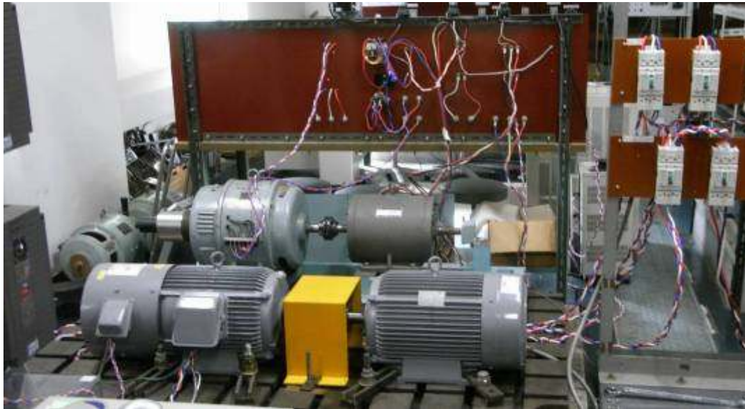
圖五: MMCC-DSCC 測試環境
