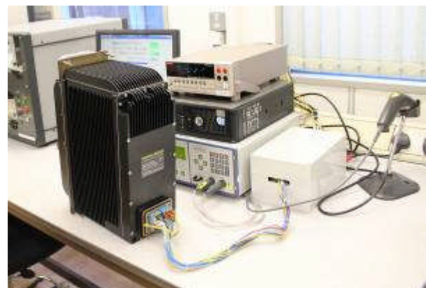
ATP 接地導通及絕緣測試
