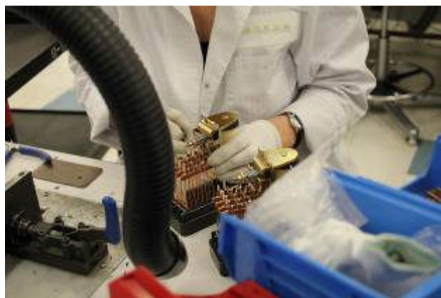
號誌繼電器人工組裝
