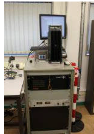
ATP 與 ATO 功能測試平台(LabView 自動測試系統)
