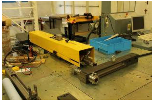
轉轍器動作桿推力測試平台
