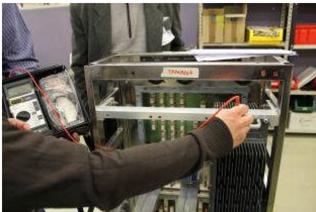
TIU 模組接地測試
