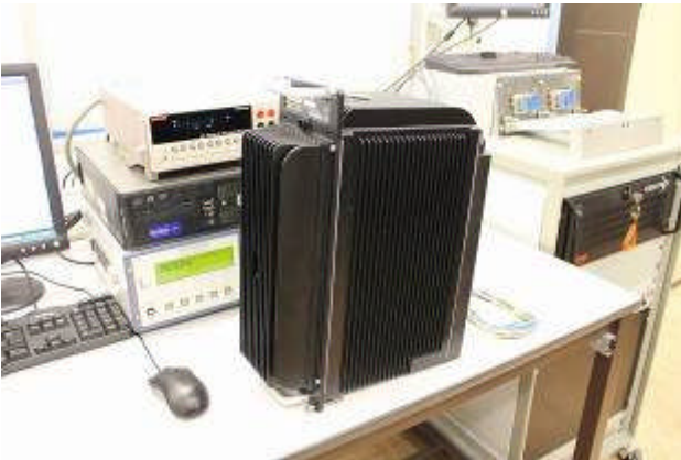
ATO 接地導通及絕緣測試
