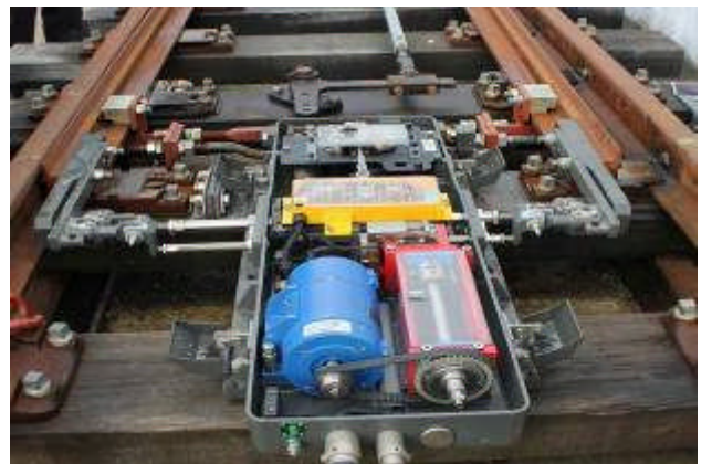
Surelock 轉轍器安裝於工廠測試軌
