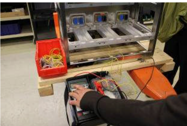
TIU 遮蔽式多芯電纜耐壓測試
