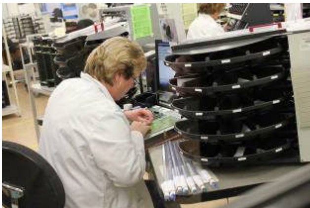
電路板人工插件(利用雷射標示位置)
