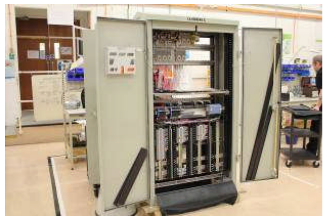
戶外型號誌設備箱組裝
