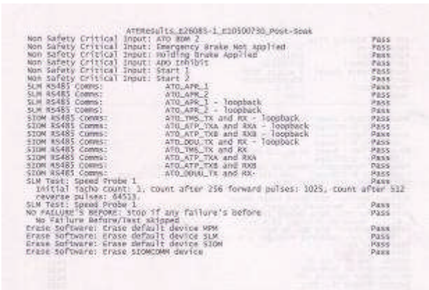
ATP 功能測試 Post-Sock(Pass)
