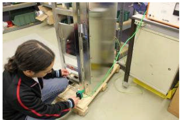
TIU 接地測試(接地螺栓與接地螺栓)
