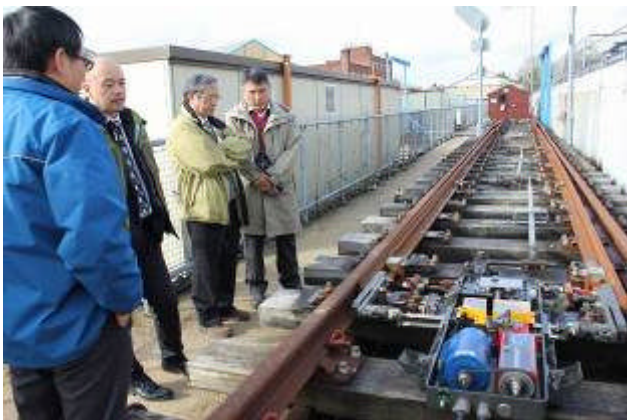
Surelock 轉轍器安裝於工廠測試軌
