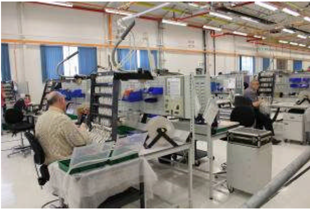
號誌繼電器底座人工組裝及配線
