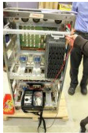
TIU 模組接地測試
