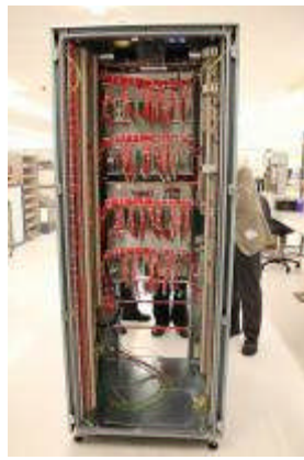
青埔機廠測試軌號誌房機櫃組裝配線
