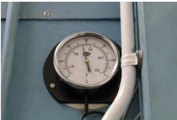
ATP 環境測試 Soak-Test 測試箱溫度 55°C
