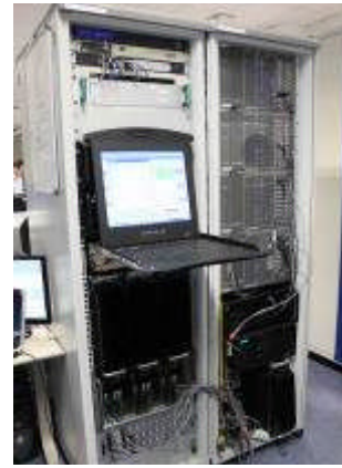
Victoria line 號誌車載設備組成
