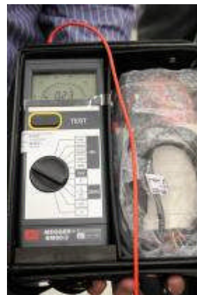
TIU 模組接地測試
