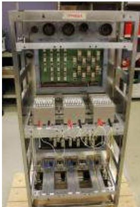
TIU 功能性測試繼電器測試顯示盒.
