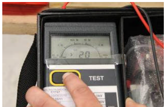
TIU 遮蔽式多芯電纜耐壓測試
