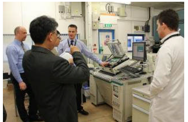
電路板件自動測試平台
