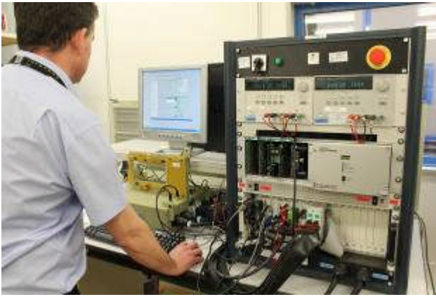
FS3000 軌道電路傳訊器功能測試平台
