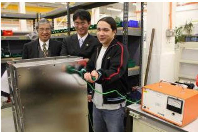
TIU 接地測試(接地螺栓與後方可拆式面板)
