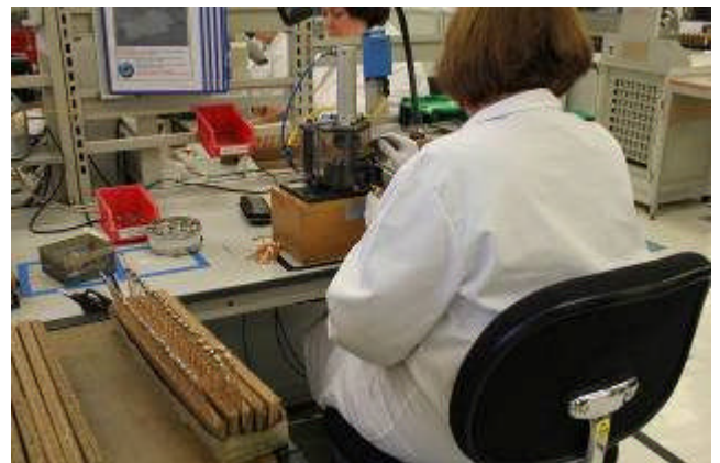
號誌繼電器接點人工製造
