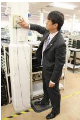
進入電子設備製造及測試區前之防靜電測試
