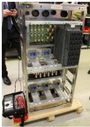
TIU 模組接地測試
