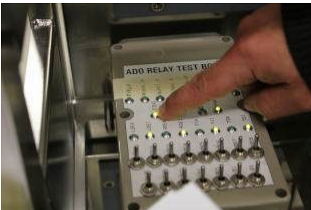
TIU 功能性測試核對燈號顯示情形
