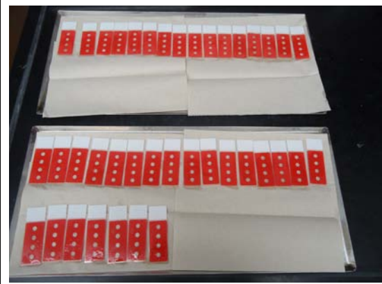
圖六、清洗後玻片置於空氣中風乾
