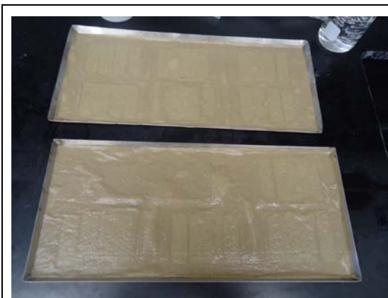
圖三、以鋪上濕潤擦手紙之不銹鋼盤作為 wet chamber 之容器
