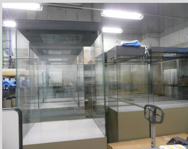
圖 99：展櫃上方的燈櫃包含兩種光源，一是一組 LED 燈（中央方形），以及 4 組投射燈（四角圓形）。(陳麗春攝)
