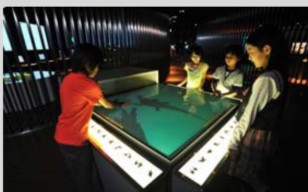
圖 34：Holowall Table，手的影子被桌內的紅外線攝像機所捕捉，然後投射出相應的 CG 畫像。(禁止攝影，改用網站截圖)
