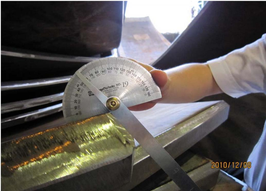
圖二十：鋼板開槽角度研磨
