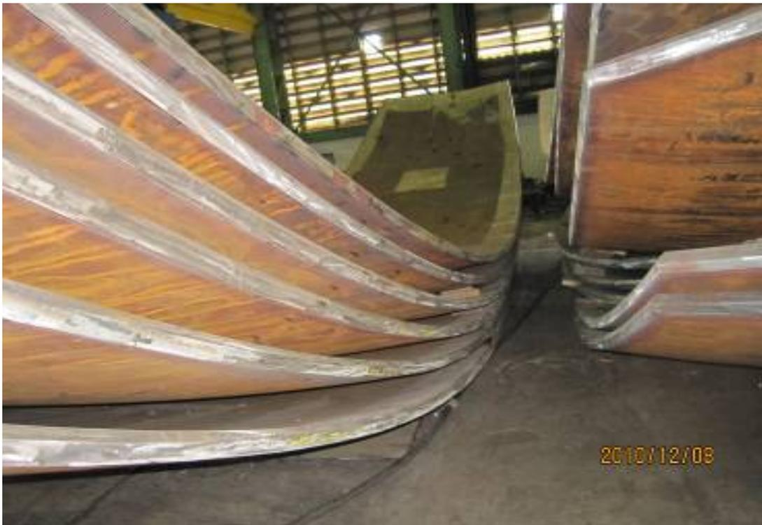
圖二十三：開槽面防銹處理完運送至廣場置放等待船運情形
