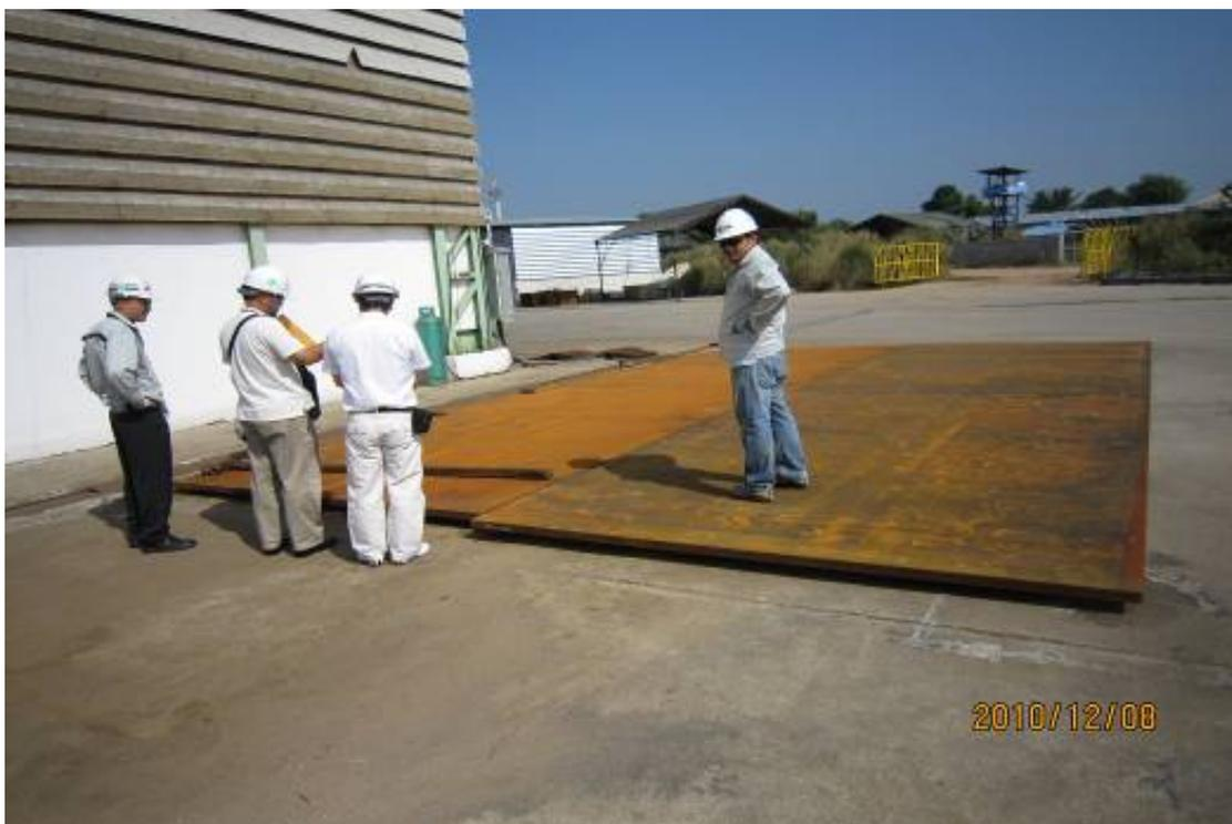
圖九：鋼板超音波厚度量測
