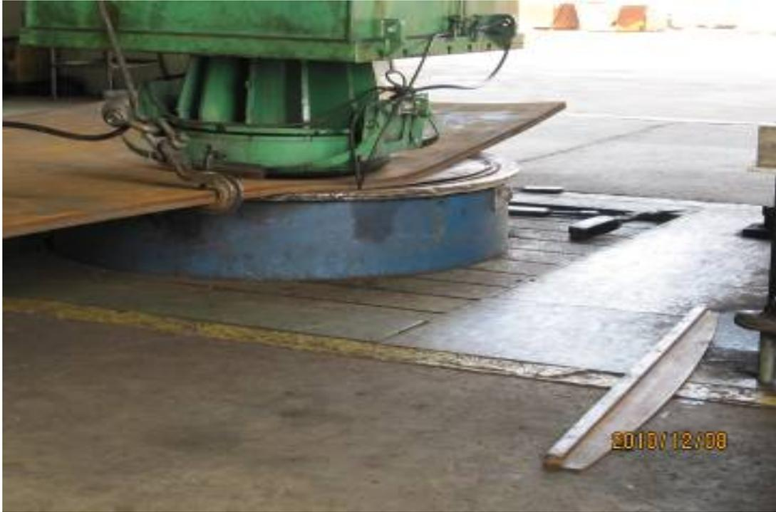
圖十三：油壓床衝擊鋼板接近完成期
