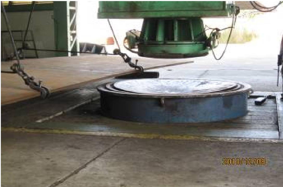
圖十二：油壓床衝擊鋼板初期
