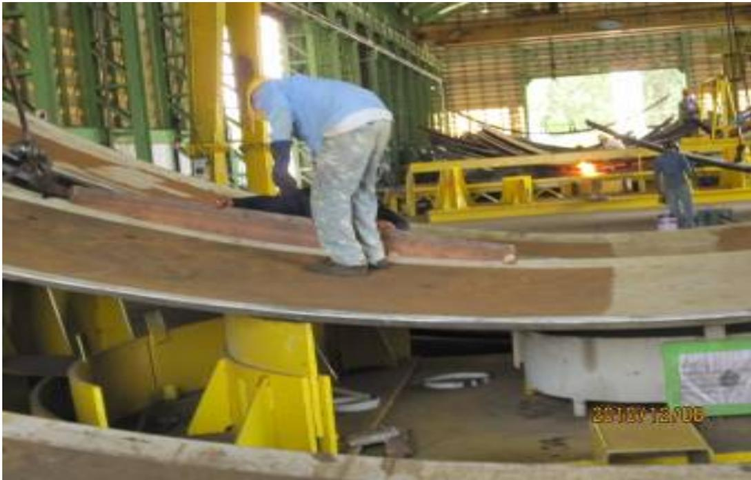
圖十七：球體曲率量測不合格作標誌待重新修正
