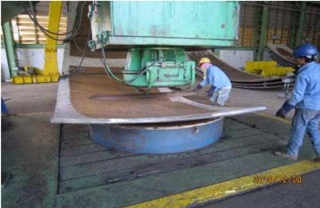
圖十九：切割完成未研磨修正前角度量測情形
