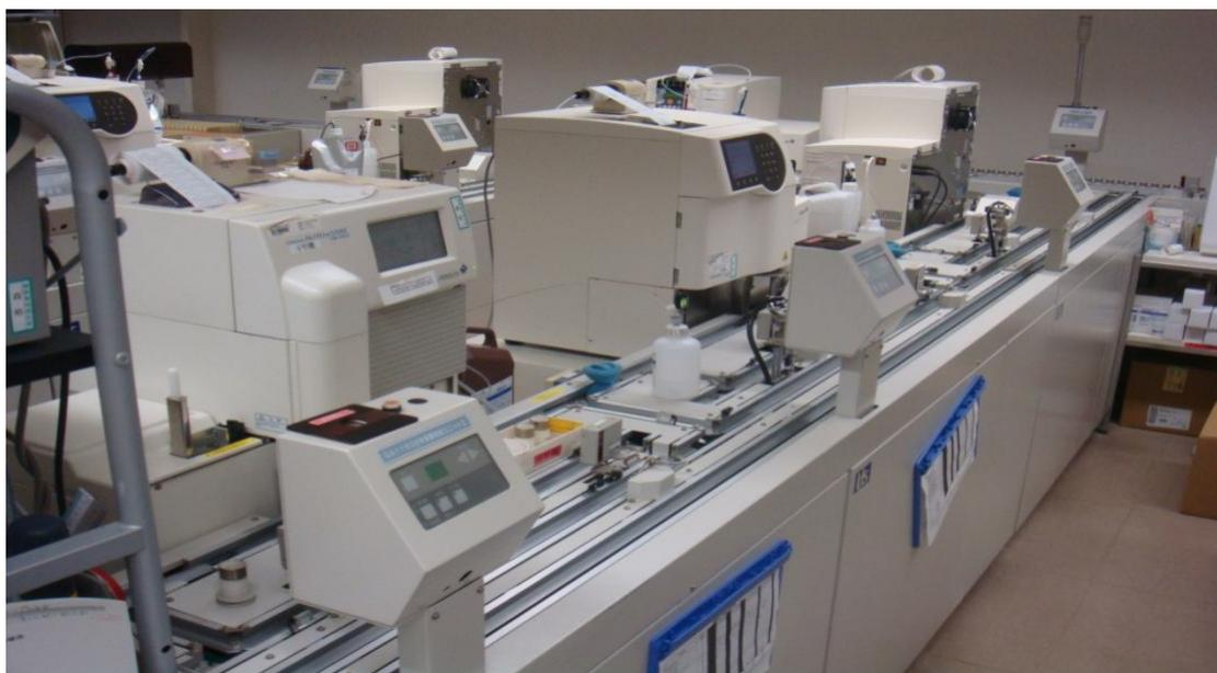
附圖 6. 以自動化軌道連接血糖分析儀及醣化血色素檢驗儀器
