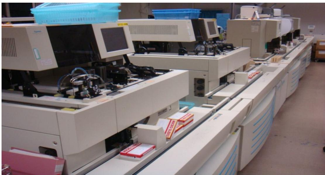
附圖 5.軌道串聯血液自動化分析儀器及推片機
