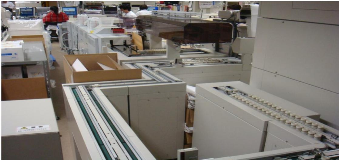
附圖 7. 自動化軌道連接生化免疫分析儀
