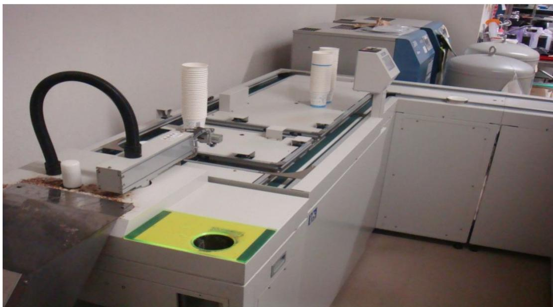
附圖 10. 以軌道將多餘尿液檢體自動傾倒廢液槽及尿液檢體杯收集
