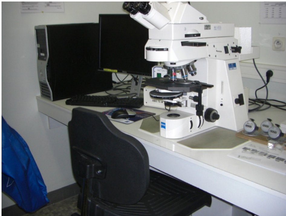
圖 8. 精液品質檢查用的螢光顯微鏡
