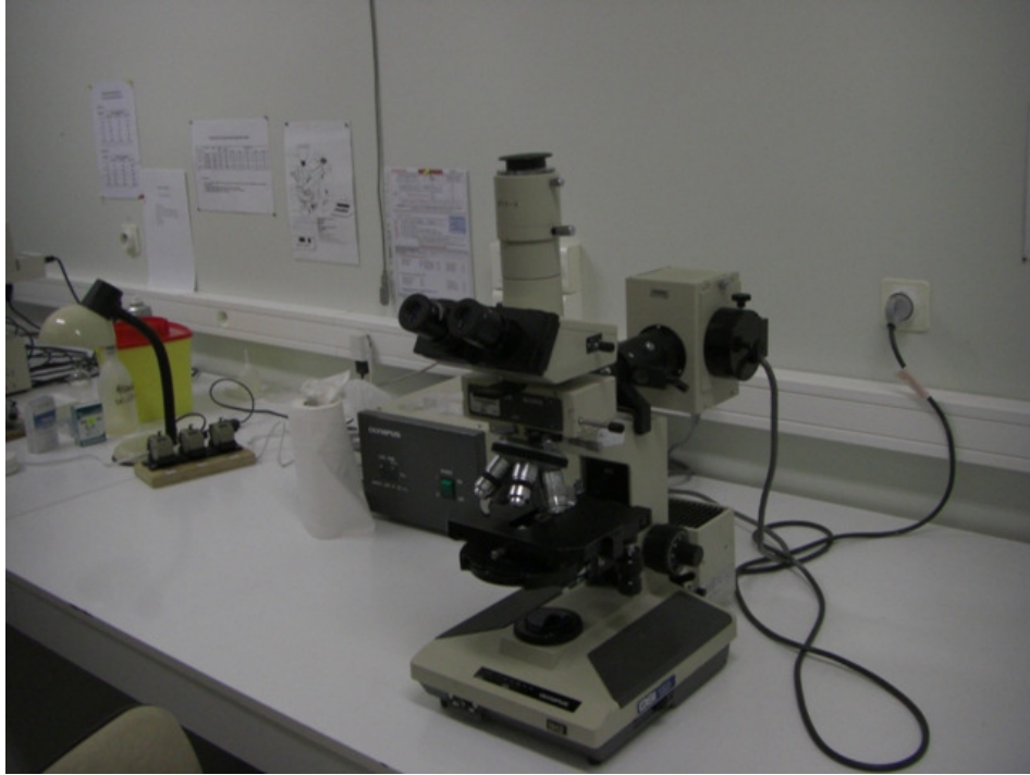
圖 7. 精液品質檢查用的光學顯微鏡
