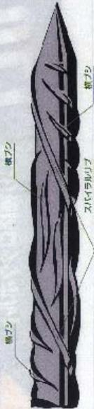
モルタルで充填されたボアホールにSNツイストボルトを挿入すると、スパイラルリブとねじりボアホールを回転させ、挿入性を高めます。結果としてリブ、フタの背面にボイドが発生するのを防ぎ、ボルト全長に渡って良好な付着が得られます。
