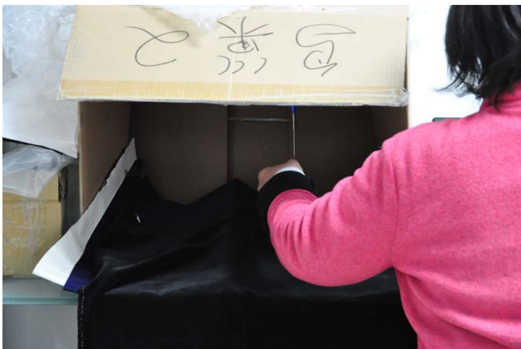
測量羽毛反射光譜時需在較暗環境下進行。
