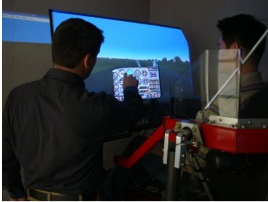
圖 23、使用動態模擬飛行器實施緊急狀況處置
