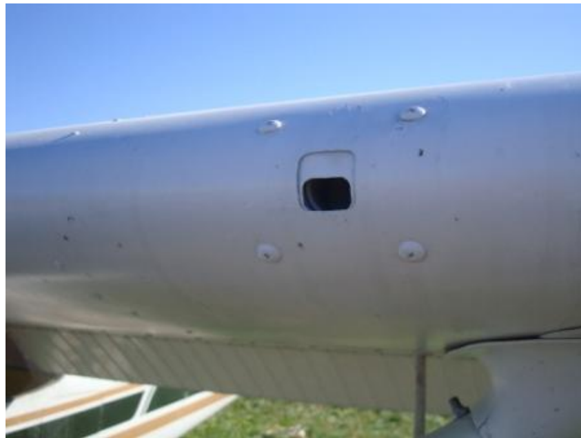
圖 8、笛音型失速警告偵測器(Cessna172 型機)
