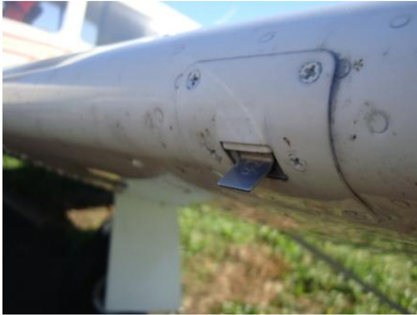
圖 7、開關型失速警告偵測器(Piper Warrior PA-28 型機)
