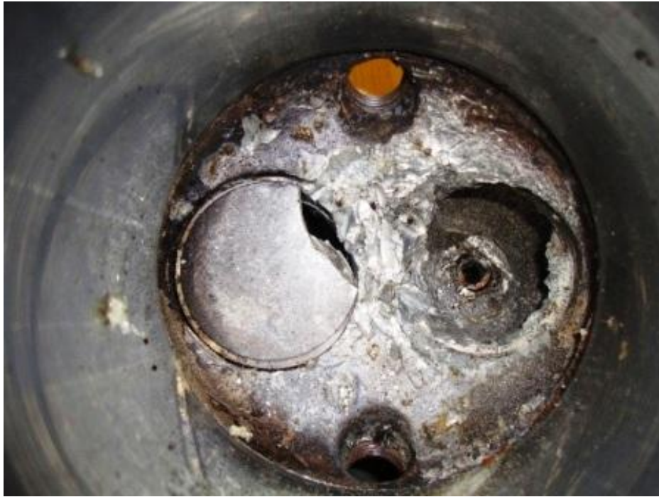
圖 22、汽缸頭殘骸內部
