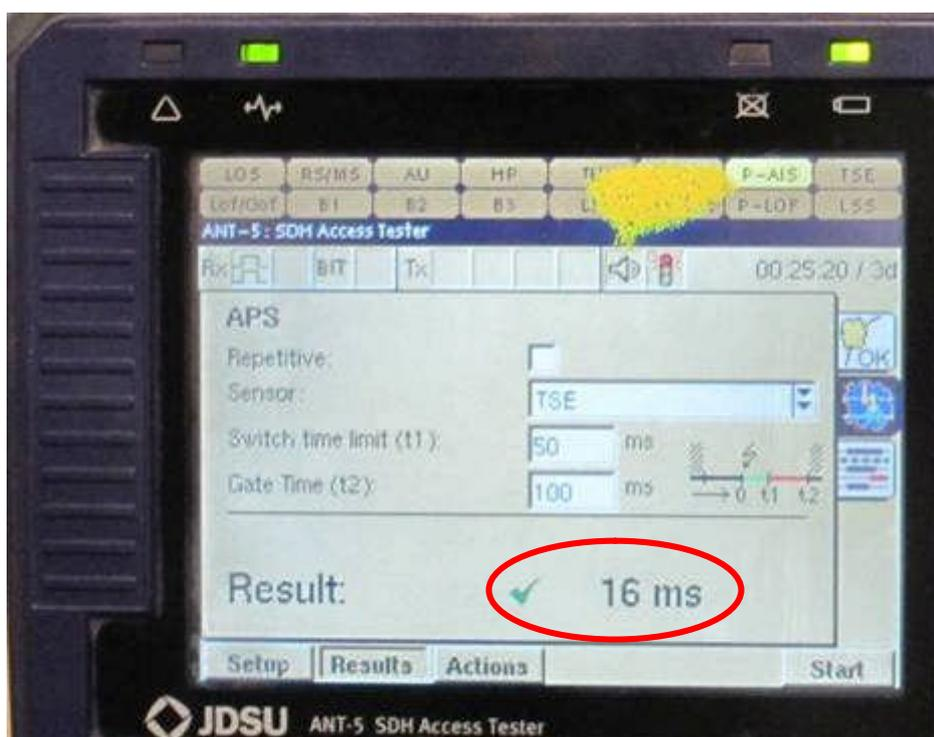
圖八十一 確認斷訊後的傳回資料所需的時間
