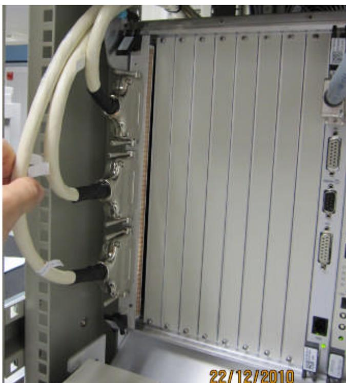
圖五十 拔除 1660SM 內的 E1 網路卡
