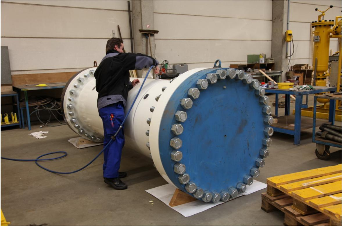
圖【三】大管徑(40吋)超音波流量計
