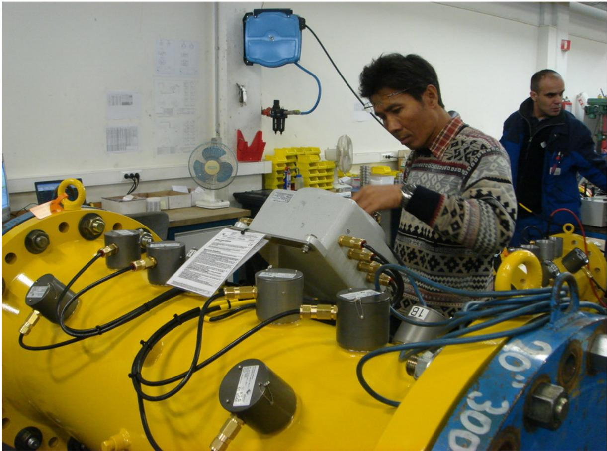
圖【五】超音波流量計查驗
