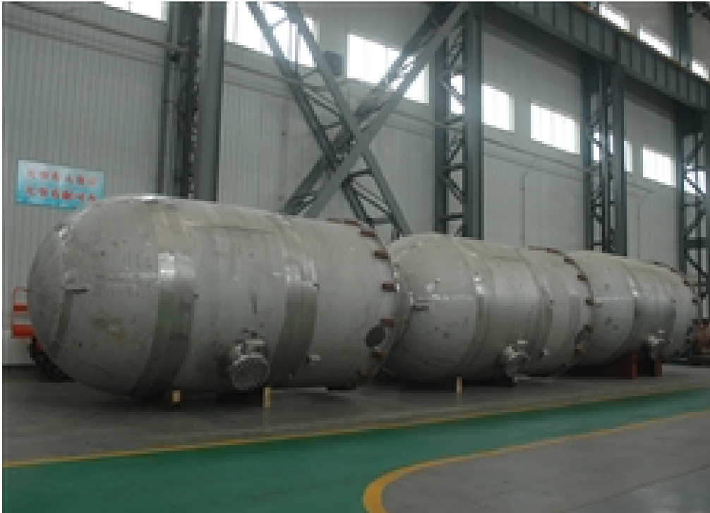
圖 2 西核公司承製之壓水式核能電廠安全注水槽
