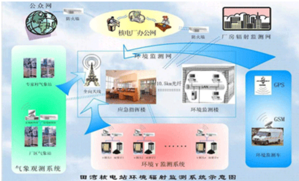
圖 5 田灣核電廠環境輻射監測系統示意圖
