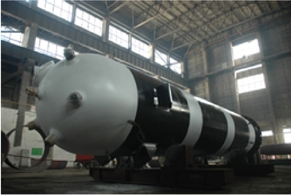
圖 1 西核公司承製之壓水式核能電廠調壓槽
