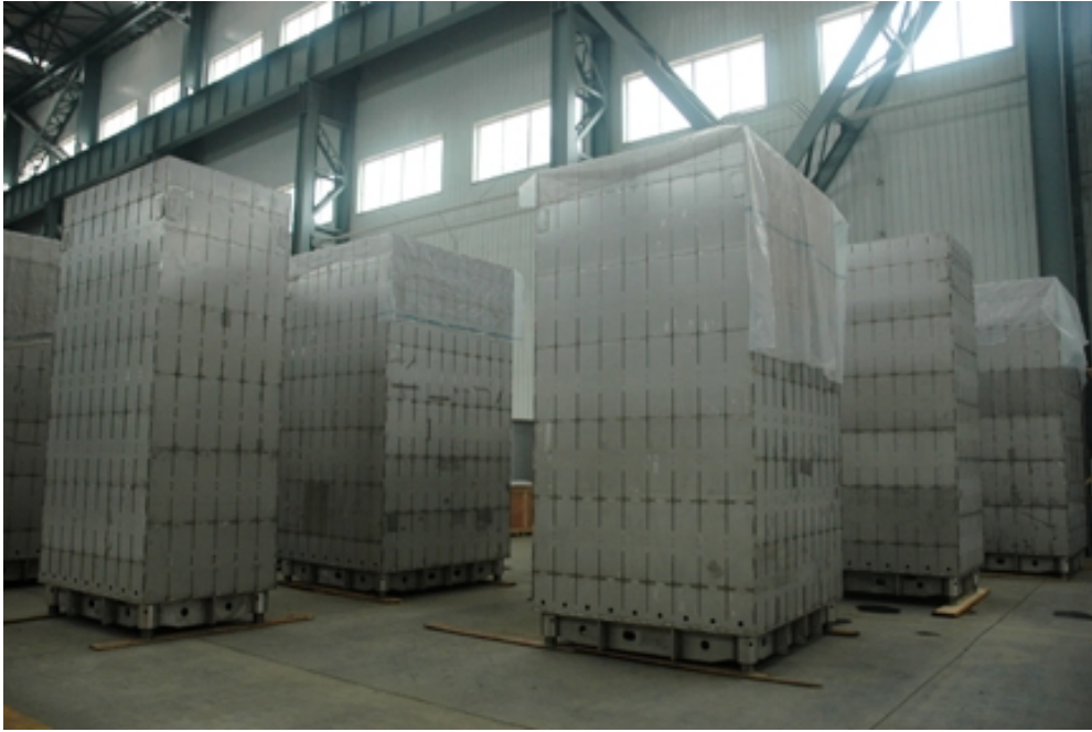
圖 3 西核公司承製之用過燃料池貯存格架
