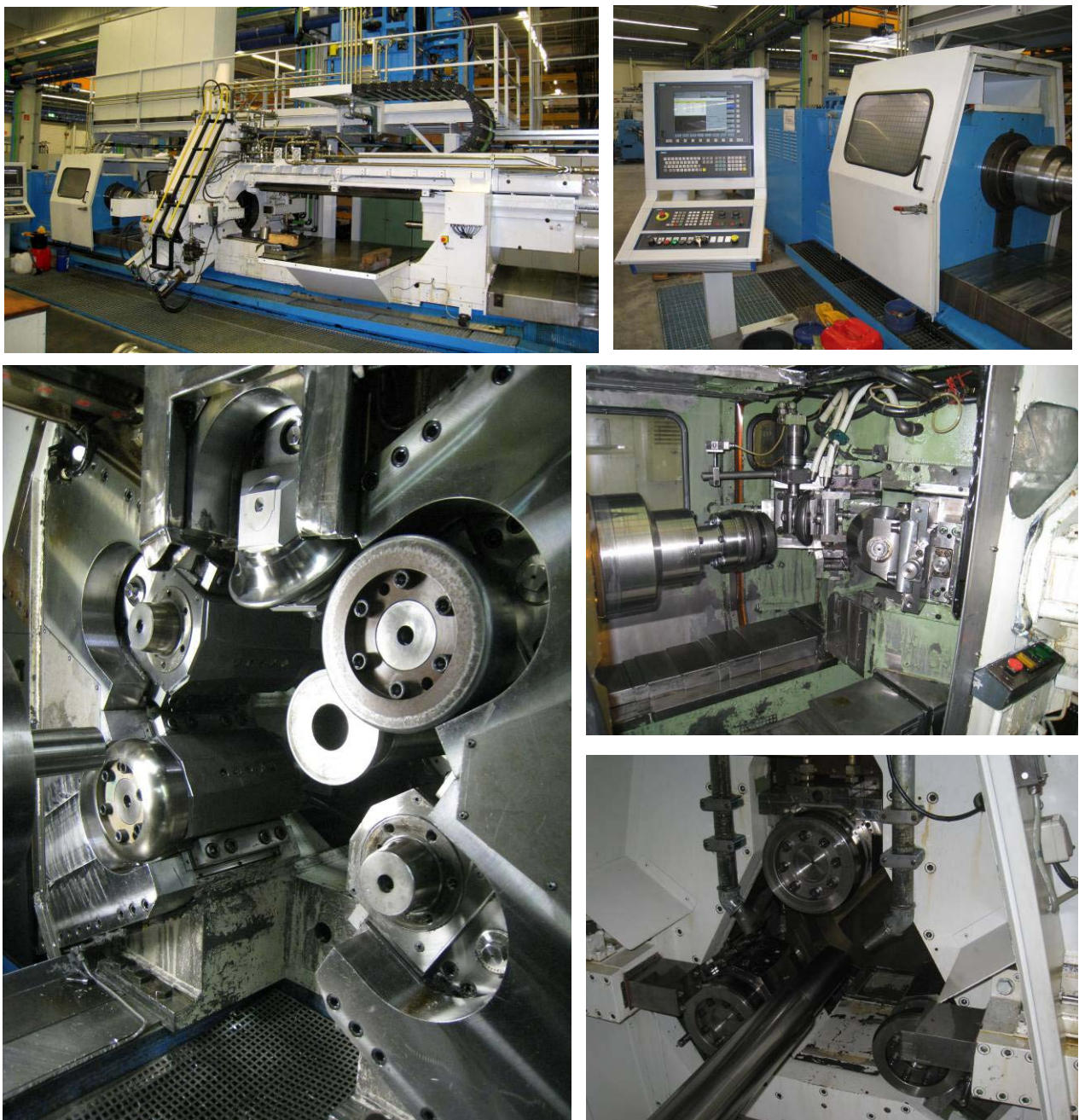
圖三、電腦數位控制之自動旋壓成型機
