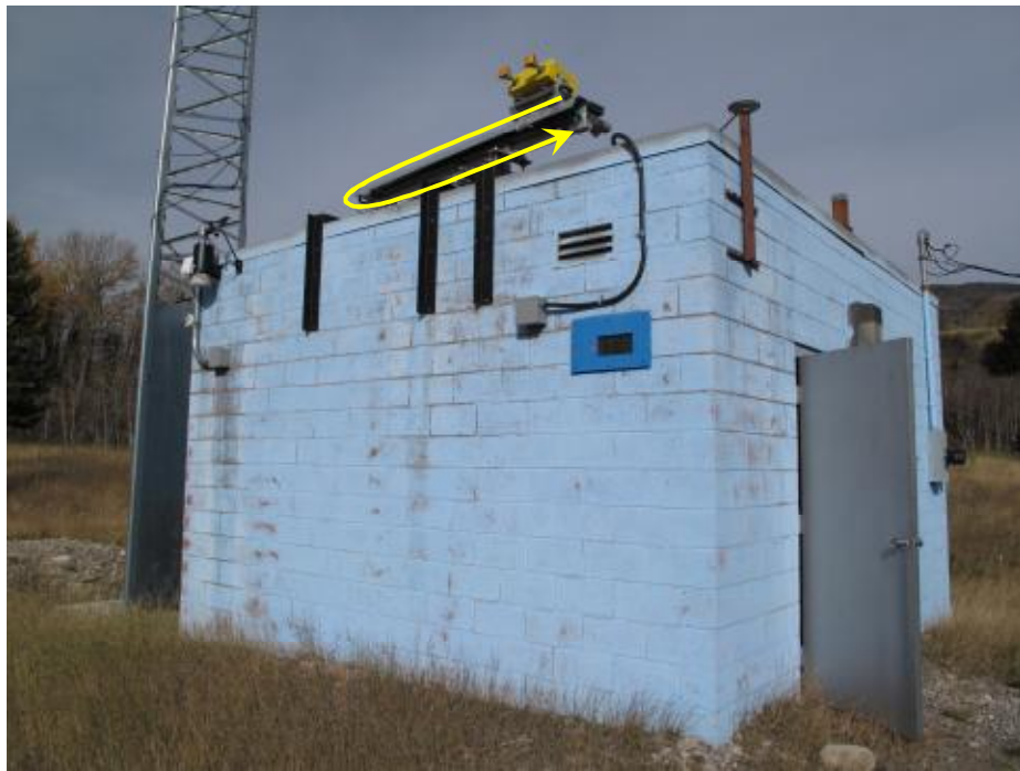
圖 28 置於屋頂上的地面干涉合成孔徑雷達(Ground-Based InSAR)掃描設備，每 5 分鐘掃描一次後會自動返回原點，重覆掃描(攝於 2010 年 10 月 18 日)。
