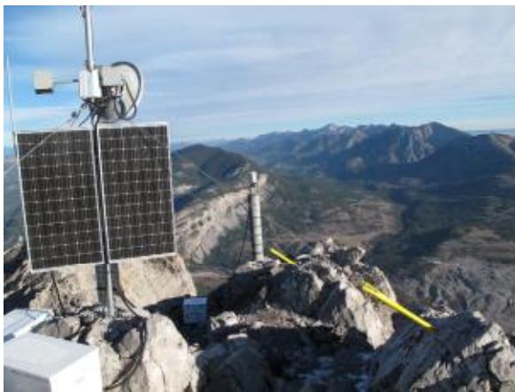
圖 14 龜山山頂上的即時監測設備及資料傳輸裝置。
