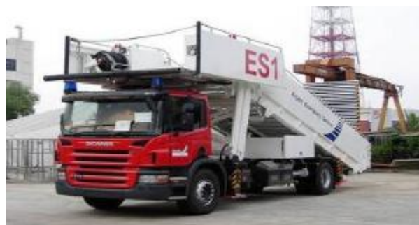
圖、第十級消防能量及供上層疏散車
