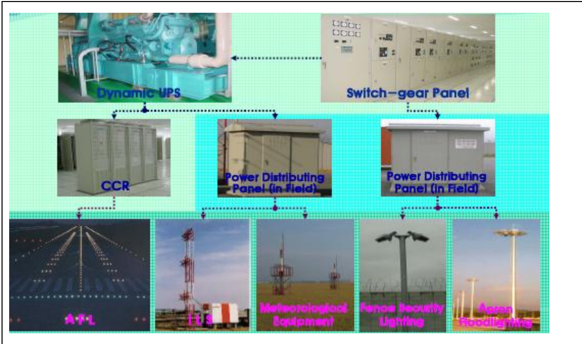
圖、目視助航設施電力系統供應圖
