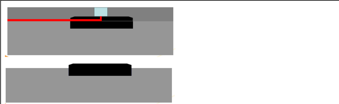
圖、洗刨瀝青面層／拆除混凝土基腳
