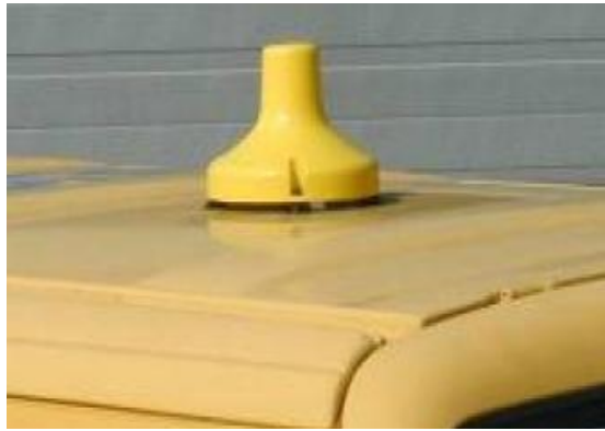
圖、飛航區車輛裝置ADS-B位置匯報器
