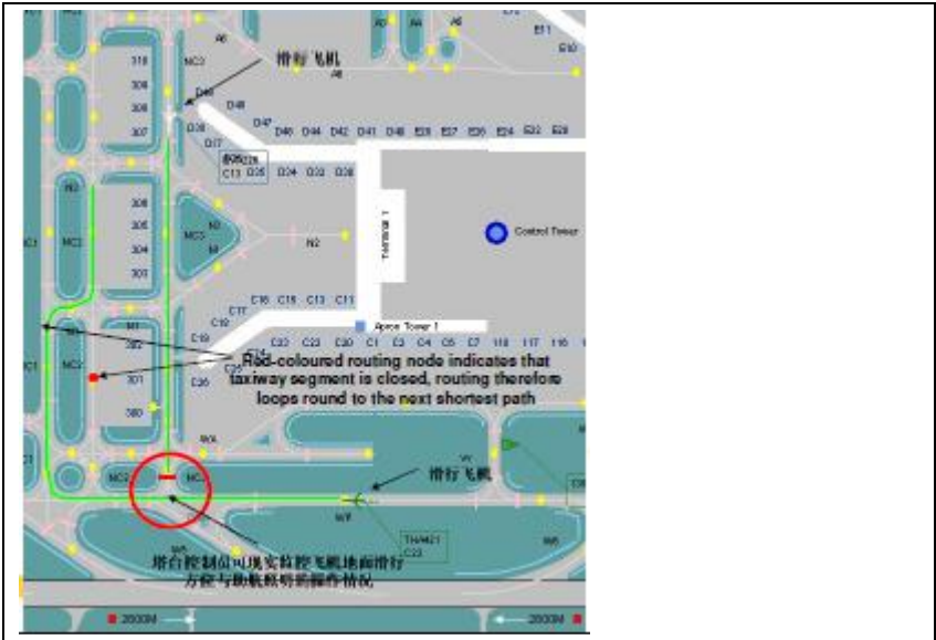
圖、燈光控制與地面雷達的銜接
