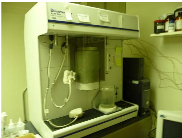
圖 8. Angela D. Lueking 教授實驗室之 Micromeritics ASAP 2020 低壓氫氣吸附量測系統。
