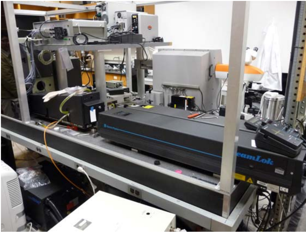
圖 16. Angela D. Lueking 教授實驗室之 In-situ Raman Microscope 分析法所使用之入射光源。
