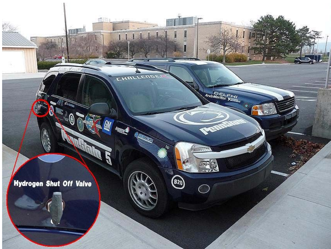
圖 36. 停放於 PSU 校園中之氫能源車，紅色圓圈放大圖為氫氣氣體開關之閥件。
