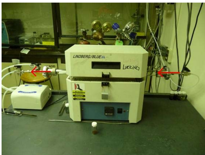
圖 17. Angela D. Lueking 教授實驗室之管型加熱爐，紅色箭頭為通入氣體流動方向。
