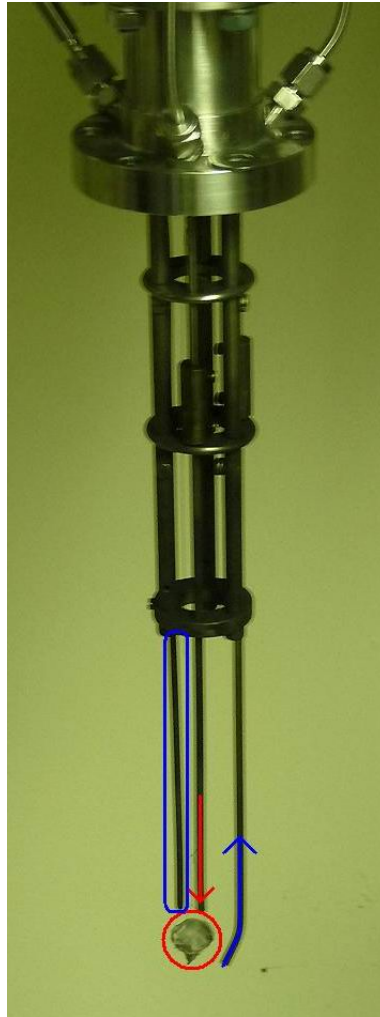
圖 30. Angela D. Lueking 教授實驗室 IGA 儲氫量測系統之 Sample Chamber 內部構造，紅色圈內為不鏽鋼網狀 Sample Holder，藍色框框則為電偶感應式溫度計，紅色箭頭為填充氣體時流入方向，藍色箭頭為抽真空時氣體流出方向。
