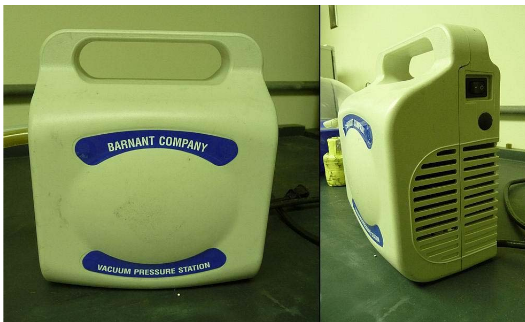
圖 40. Angela D. Lueking 教授實驗室使用之電動抽氣 Pump 照片，左圖為正面，右圖為側面。
