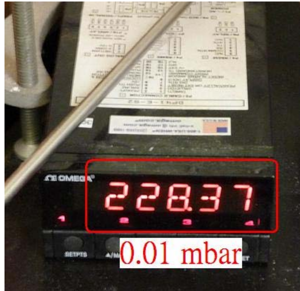
圖 23. Ralph T. Yang 教授實驗室 Volumetric Measurement 儲氫量測系統之壓力計顯示表，紅色方框為當時壓力計實際讀值，解析度可達 0.01 mbar。
