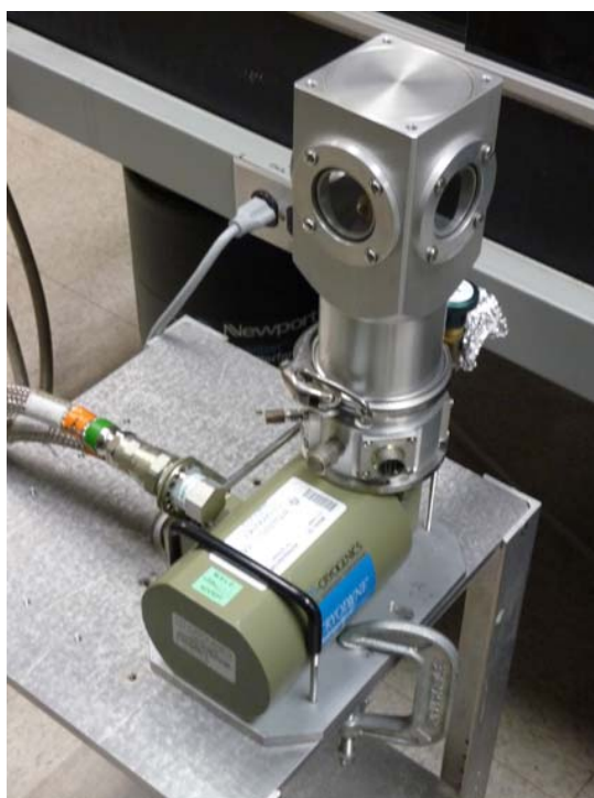
圖 15. Angela D. Lueking 教授實驗室之 In-situ Raman Microscope 分析使用之 Sample Chamber。
