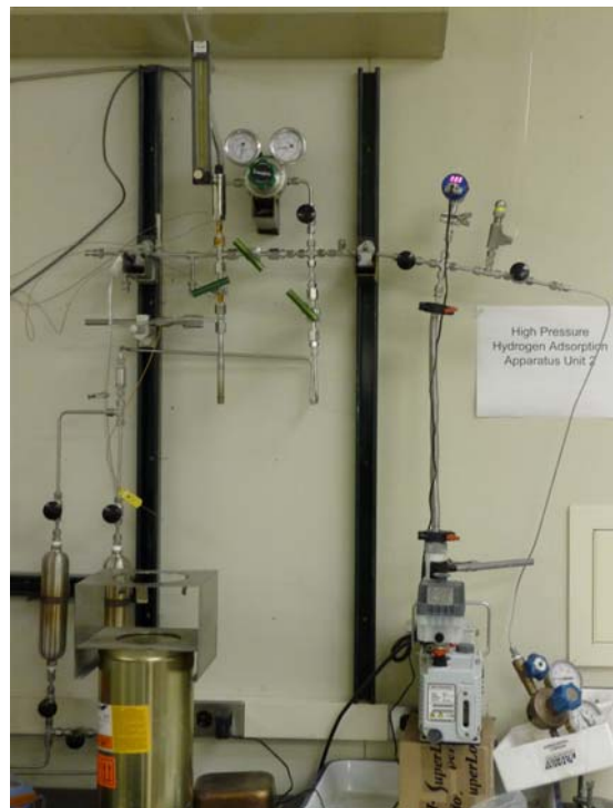
圖 3. Ralph T. Yang 教授實驗室之 Volumetric Measurement 儲氫量測系統。
