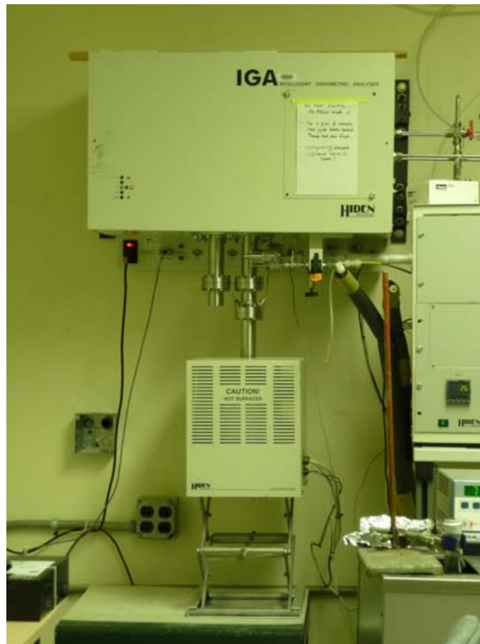
圖 11. Angela D. Lueking 教授實驗室之 IGA 儲氫量測系統。
