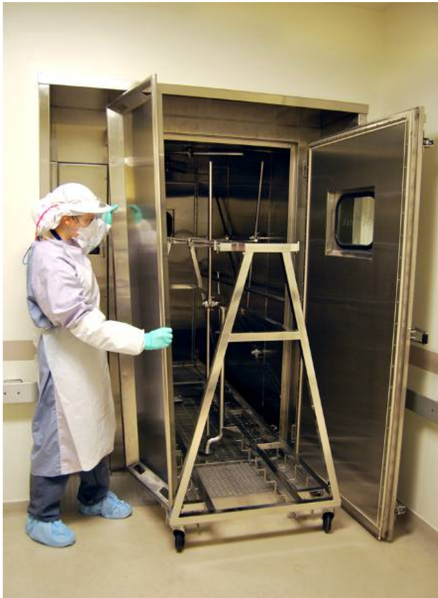
附圖九：解剖臺上屍盤須置入解剖室內之大型單門高壓滅菌器消毒
