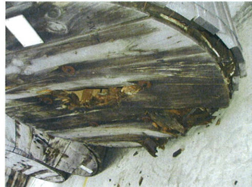
木質線軸腐朽情形
