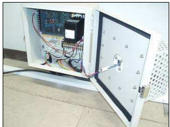
照片 3-21 伽凡尼電池方式氧氣濃度感應器
