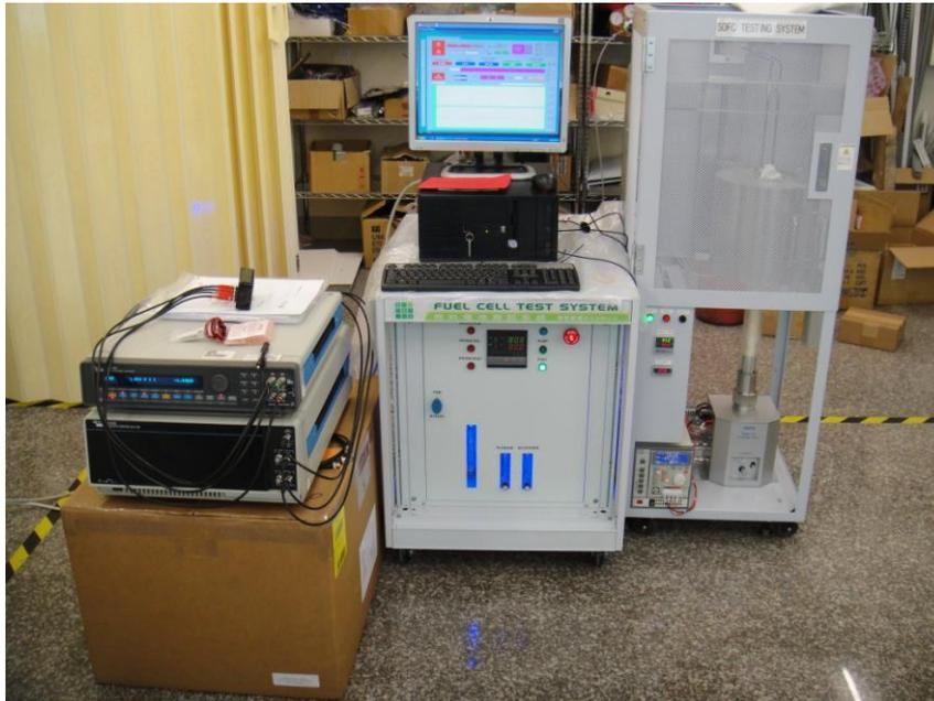
圖 1. CHINO Bottom cell 的測試平台
