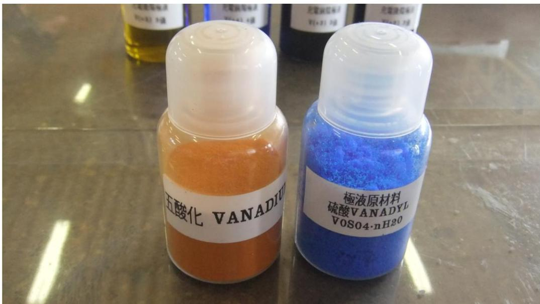
圖 10  $V_2O_5$  及硫酸鹽結晶
