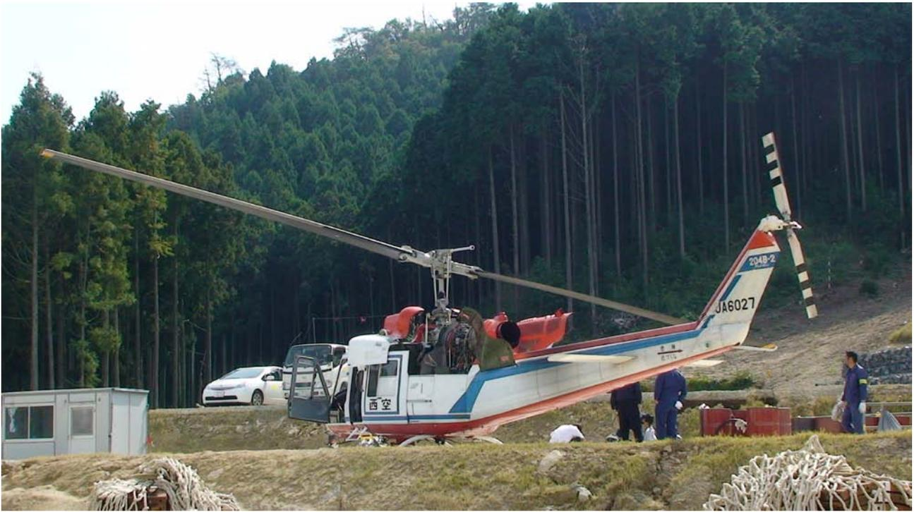
圖 3-7、應用直昇機於鐵塔工事示意圖-1
