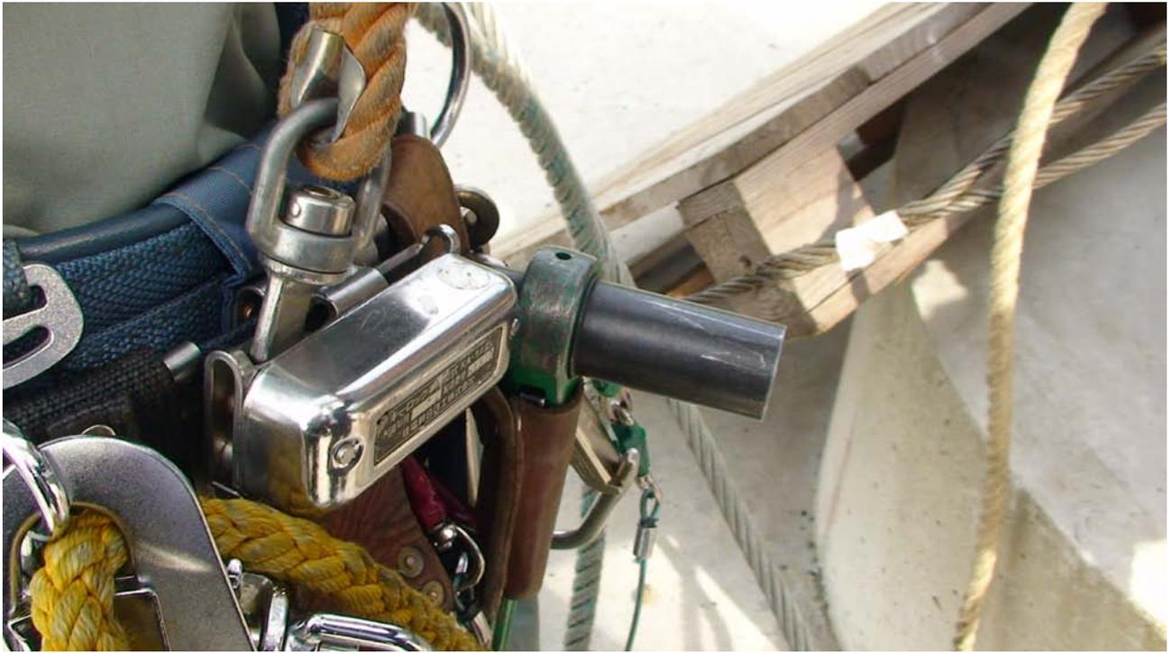
圖 3-9、防墜裝置「Key-Lock」使用示意圖-1
