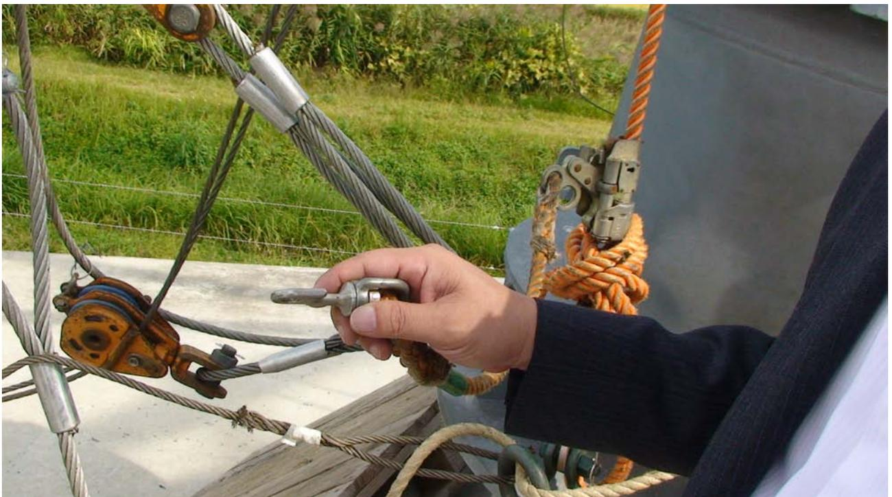
圖 3-10、防墜裝置「Key-Lock」使用示意圖-2
