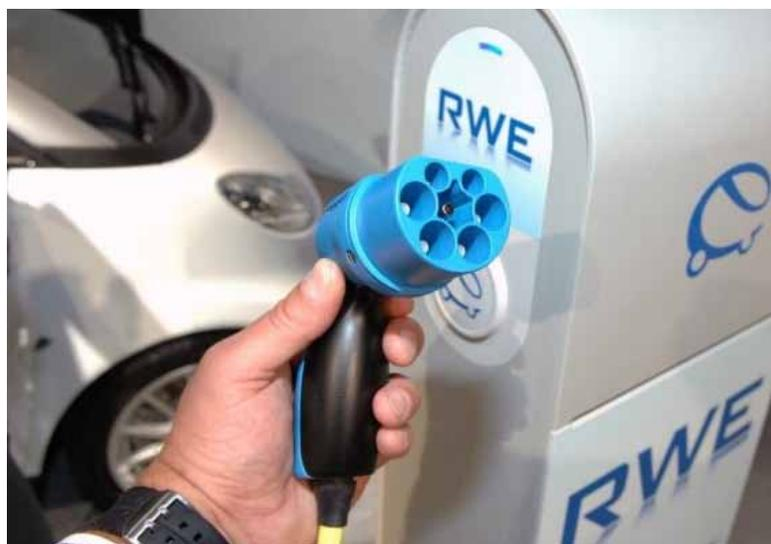
圖 6：RWE 直立式充電柱與充電連接器車輛端插頭
