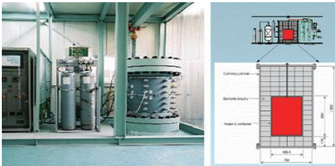
圖 2-3-25 用以進行工程規模之溫度-水文-力學-化學(THMC)試驗之 KENTEX
